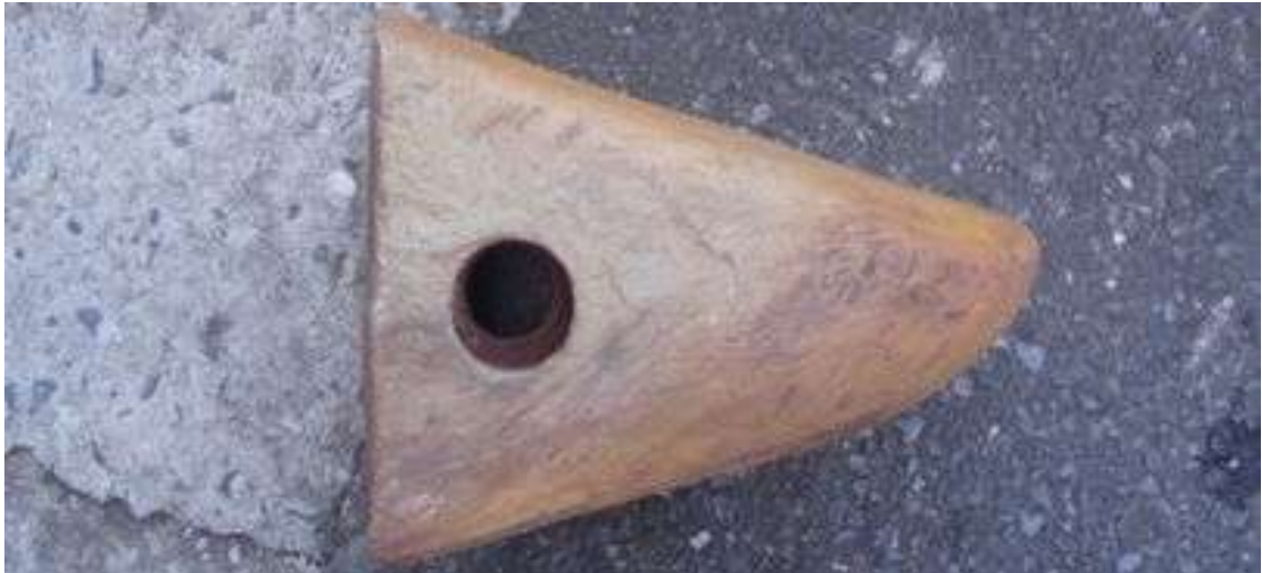
Figura 4.22 - Ponta com 160 horas de operação.
