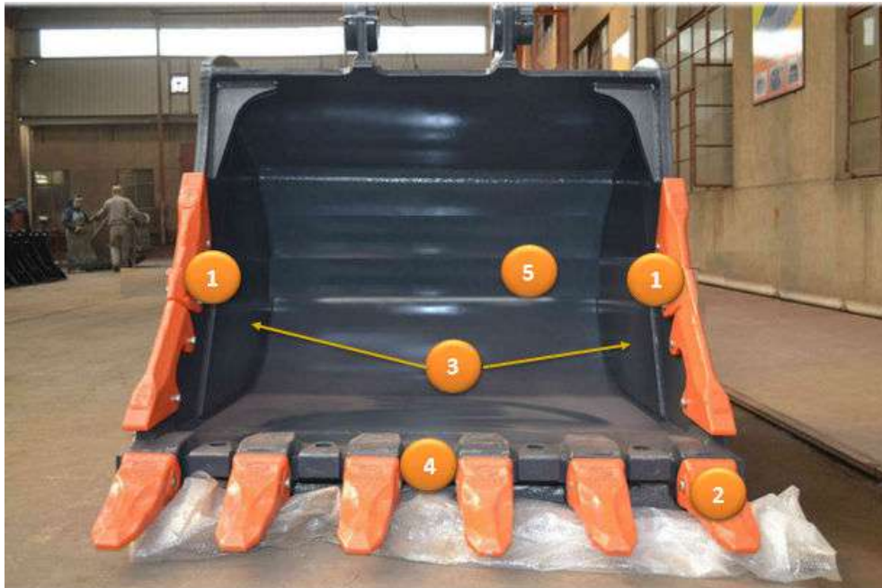
Figura 4.8 - Detalhamento frontal da caçamba com FPS e materiais de desgaste.
