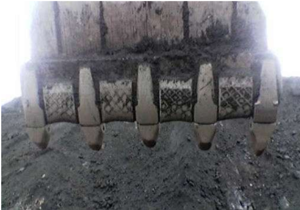
Figura 4.19 - Caçamba de uma escavadeira em operação.
