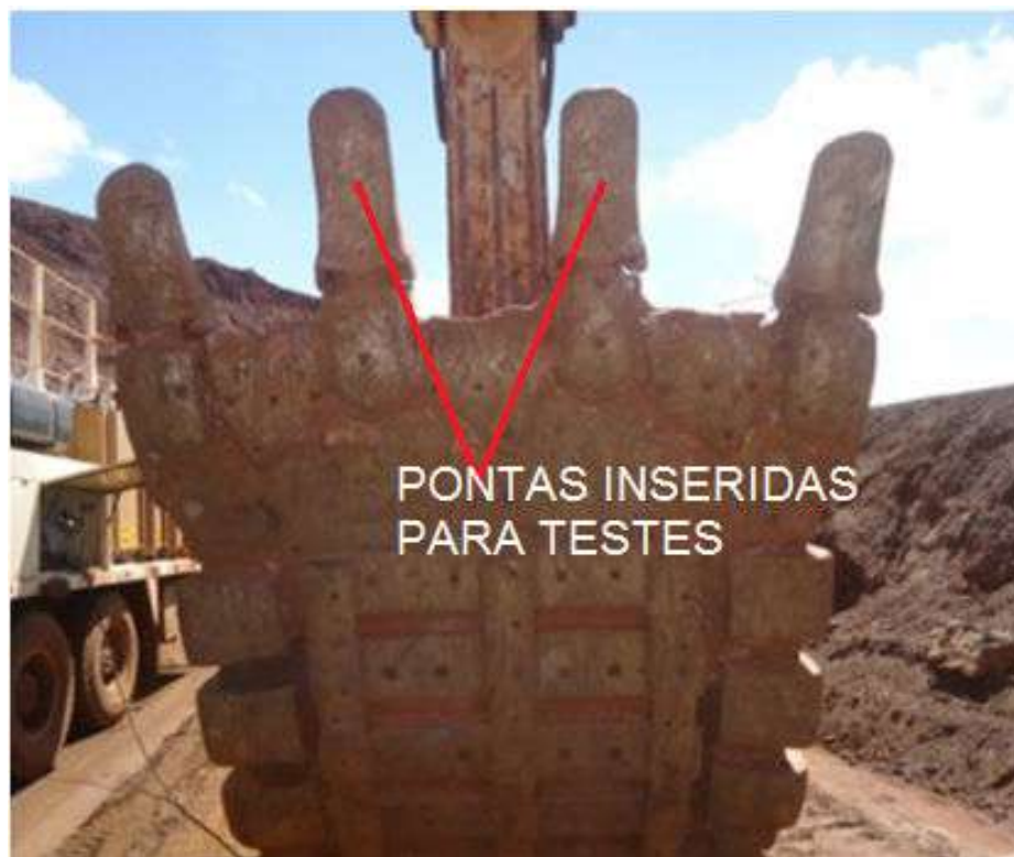
Figura 6.7 - Escavadeira com dois tipos ponta - original e com enxadrezamento 2.
