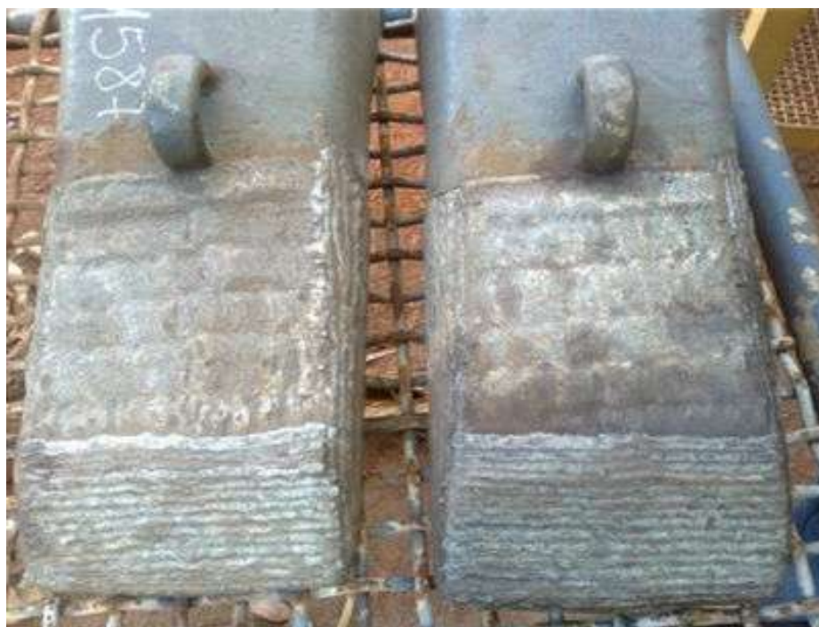
Figura 6.6 – Enxadrezamento 2 da ponta feito com o eletrodo AWS E FeCr-A1.
