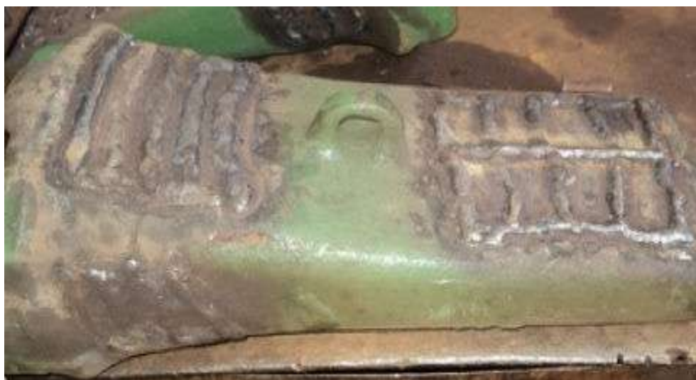
Figura 6.5 – Enxadrezamento 1 da ponta feito com o eletrodo AWS E FeCr-A1.
