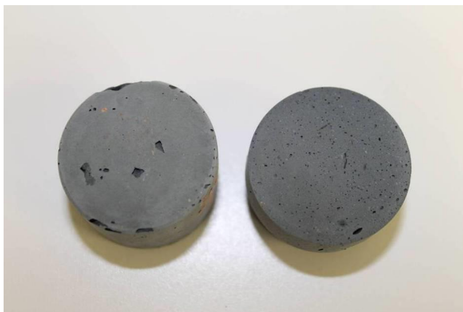
Figura 29 - Comparação entre uma pastilha sem o tratamento e outra com o tratamento superficial
