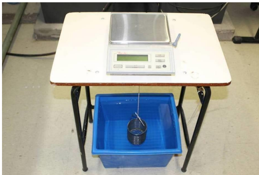
Figura 34 - Estrutura montada para execução do ensaio de massa específica, absorção e índices de vazios
