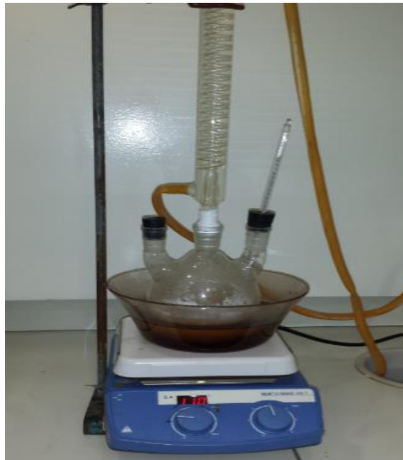
Figura 16- Esquema do processo de funcionalização da haloisita com APTES
