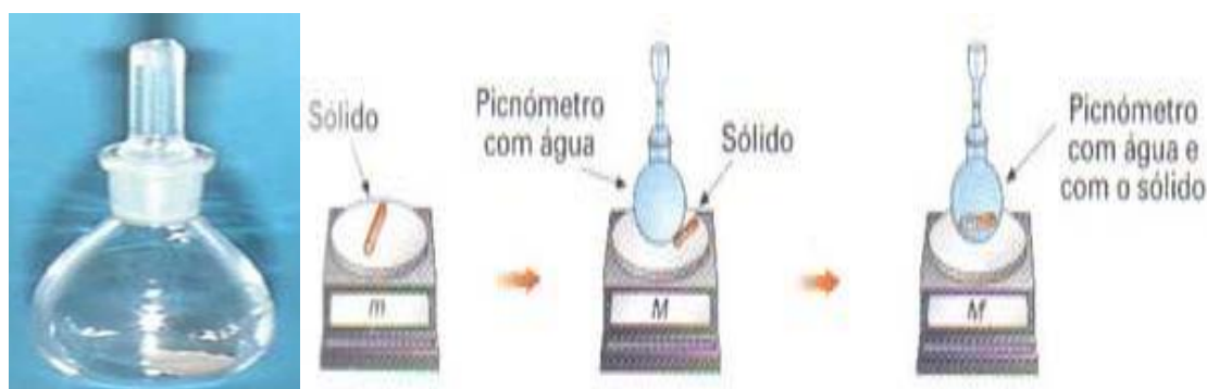
Figura 12- Picnômetro e ilustração da técnica utilizada na determinação da densidade relativa das massas cerâmicas.
