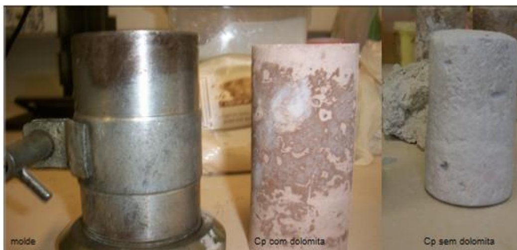
Figura 16 - Corpos de prova (52 x 110) mm com alguns defeitos superficiais.
