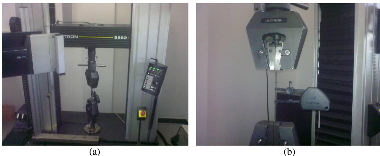
Figura 4.25 – Máquina universal de ensaios marca Instron : (a) vista geral e (b) detalhe de um dos corpos de prova durante o ensaio.
