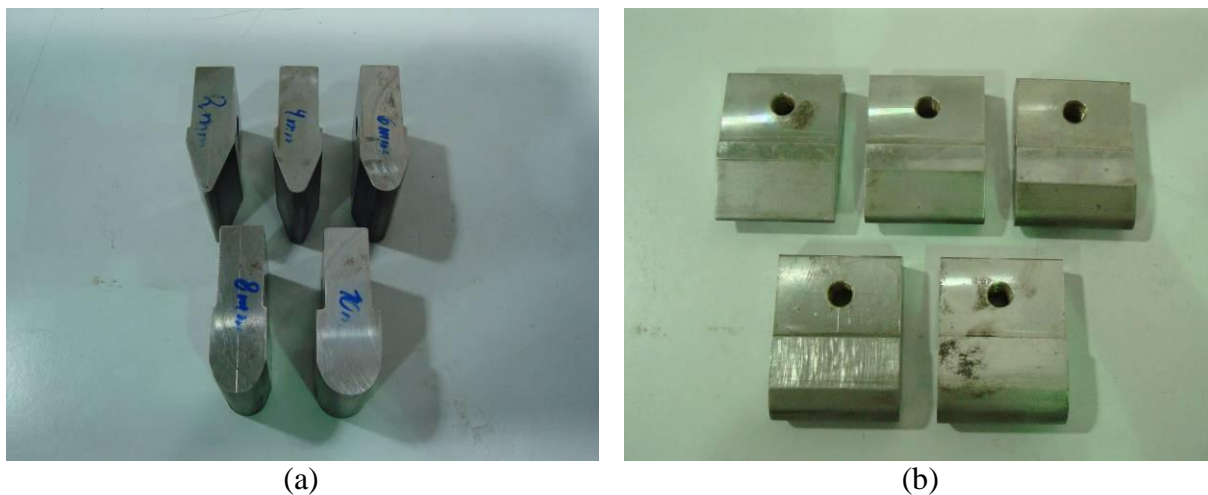
Figura 5.11 – Imagens dos cutelos com raios de 2mm, 4mm, 6mm, 8mm e 10mm confeccionados m aço AISI 1045 temperado e revenido para a realização de dobramento: (a) e (b) vistas distintas.
