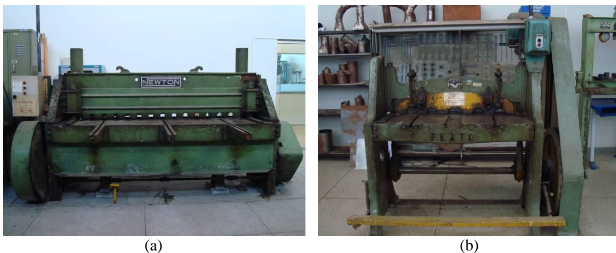
Figura 4.19 – Guilhotinas utilizadas no corte dos corpos de prova para os ensaios de dobramento: (a) equipamento marca Newton modelo TM 10 e (b) equipamento marca Pexto modelo U-136-D.
