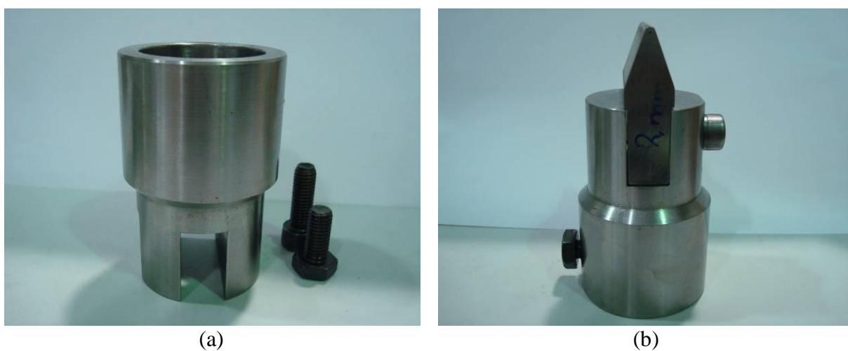
Figura 5.12 – Imagens do suporte confeccionado para adaptar os cutelos de dobramento à prensa: (a) dispositivo e parafusos e (b) dispositivo com um dos cutelos acoplado.
