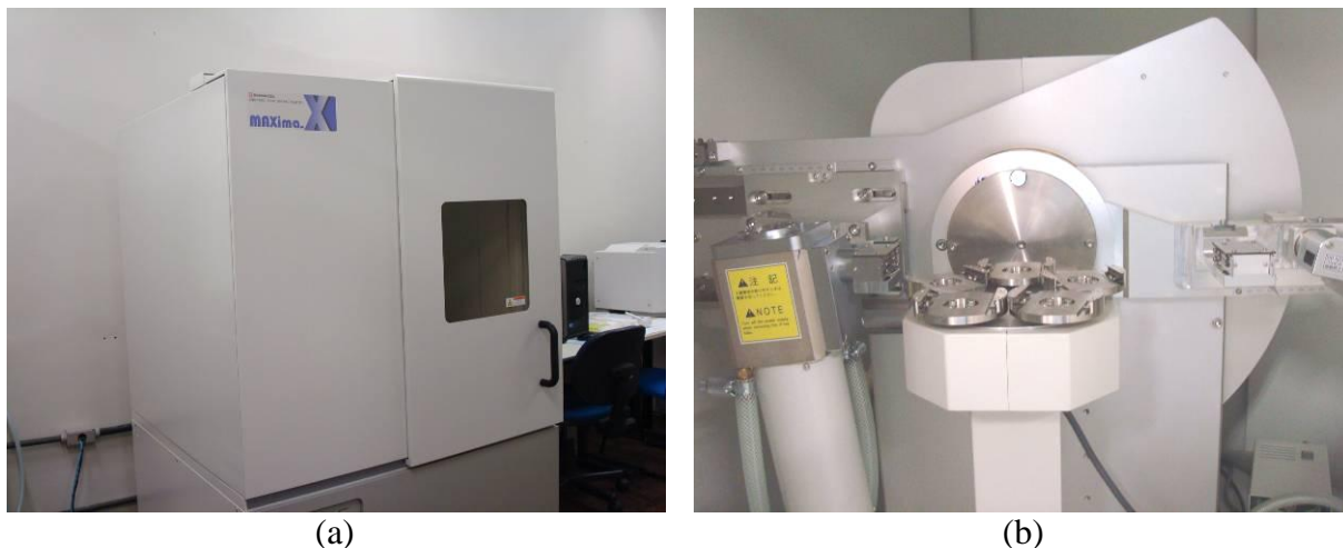
Figura 4.24 – Difratorômetro de raios-X marca Shimadzu empregado na caracterização microestrutural dos metais: (a) vista geral e (b) detalhe do sistema de fixação das amostras e goniômetro.
