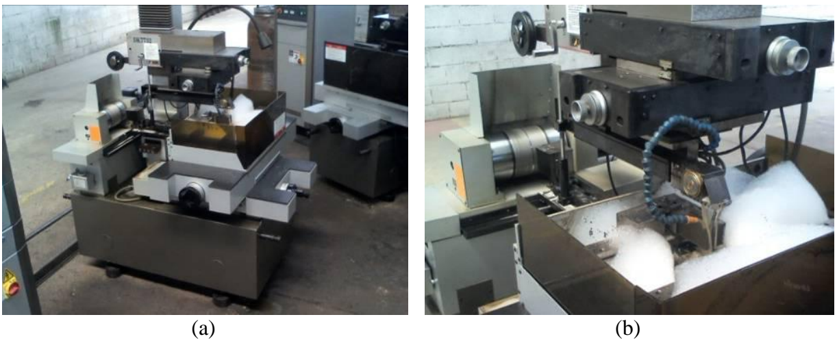
Figura 4.17 – Equipamento de usinagem por eletroerosão a fio marca Baoma : (a) vista geral e (b) detalhe da máquina em operação.
