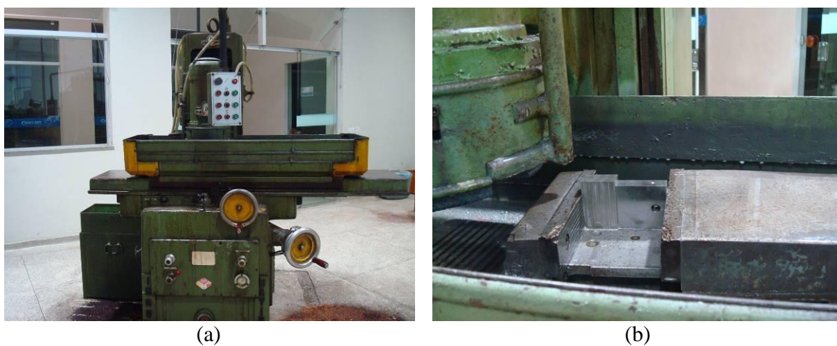
Figura 4.20 – Retificadora marca Zocca , utilizada para acertar as dimensões e o acabamento superficial dos corpos de prova para os ensaios dobramento: (a) vista geral e (b) detalhe dos corpos de prova.
