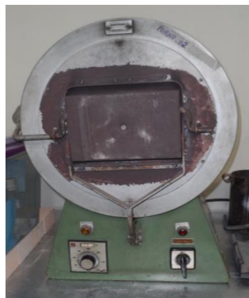
Figura 4.3 - Forno Brasimet modelo Heraus utilizado para realização dos tratamentos térmicos.
