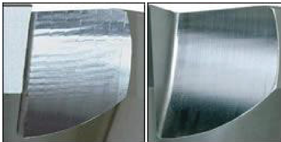
Figura 15. (a) Superfície usinada com marcas de CHATTER , (b) Superfície usinada sem marcas de CHATTER .
