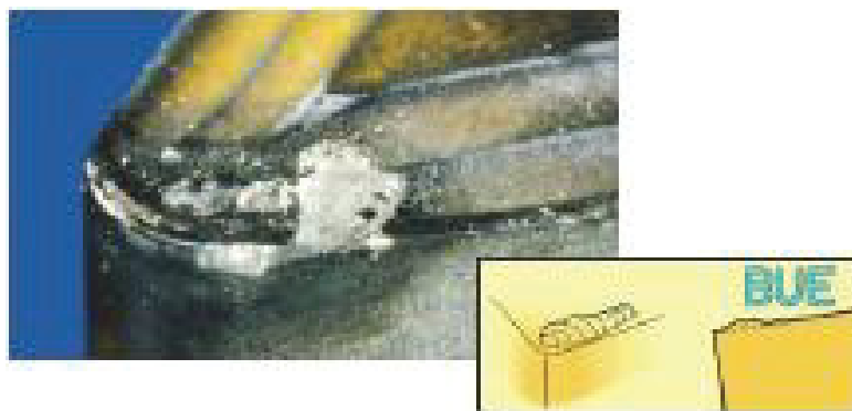
Figura 11. Aresta postiça de corte (BUE- build up edge )
