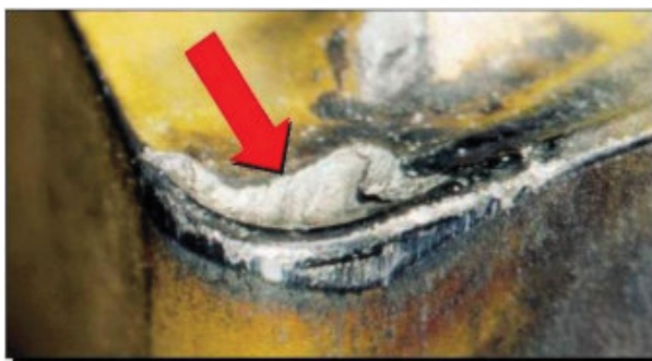
Figura 7 - Desgaste de cratera na superfície de saída de cavaco.
