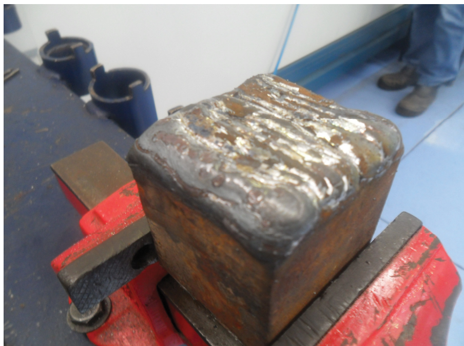
Figura 17. Revestimento de Mn e Si por soldagem MIG.
