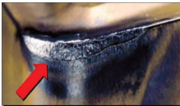
Figura 8 - Desgaste de flanco na aresta de corte e raio de ponta.
