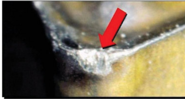
Figura 10 - Lascamento de uma ferramenta.
