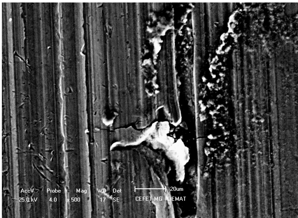
Figura 31 – Imagem MEV da trilha de desgaste na liga C (500X)
