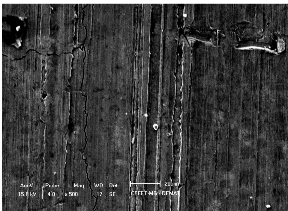
Figura 29 – Imagem MEV da trilha de desgaste na liga A (500X)
