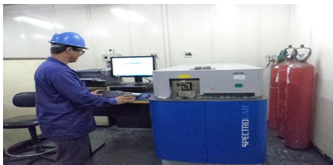
Figura 22: Espectrômetro ótico modelo “SPECTROLAB”
