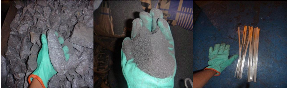
Figura 14- FeSi em pedras Figura 15- Grafite cristalino Figura 16- “Sn” em barras
