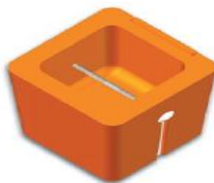
Figura 18 - Cápsula em areia “shell” para corpos de prova de análise térmica
