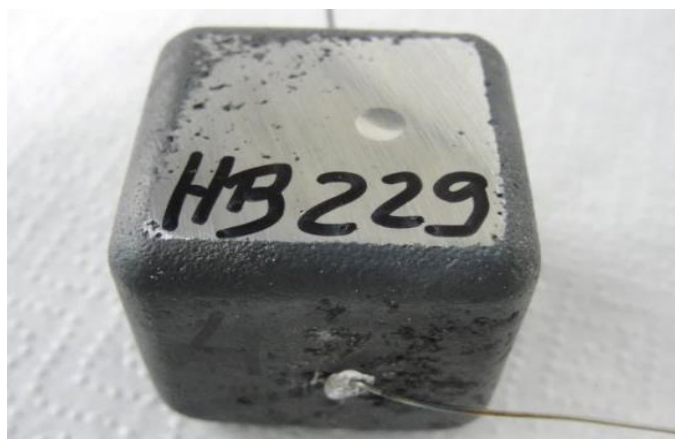
Figura 11 - Corpo de prova do teste de análise térmica
