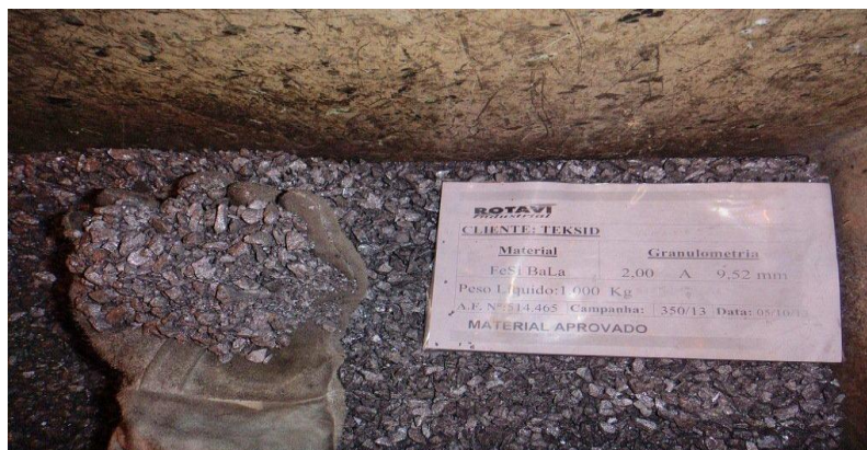
Figura 17 – Liga inoculante à base de FeSi-Ba-La (Fornecedor: Rotavi)
