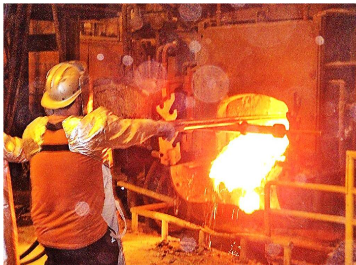
Figura 13 – Forno a arco elétrico em fase de escorificação
