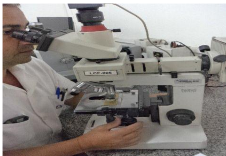
Figura 21 – Microscópio ótico “HUND Wetzlar” acoplado com câmara “Motcam 2300”
