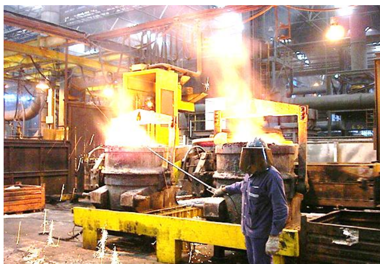
Figura 23 – Medição da temperatura com cápsula de imersão
