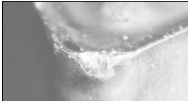
Figura 4.17 - Desgaste por lascamento
