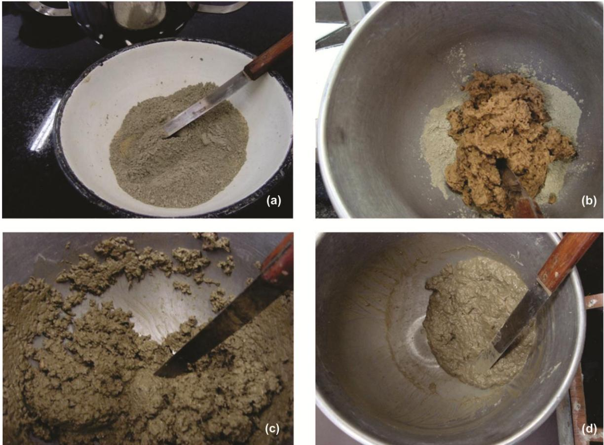
Figura 4.10 – Moldagem dos compósitos com acréscimo de fibras.
