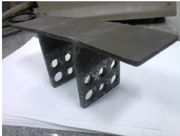
Figura 18 – Fotografia do porta-amostras utilizado nos tratamentos térmicos
