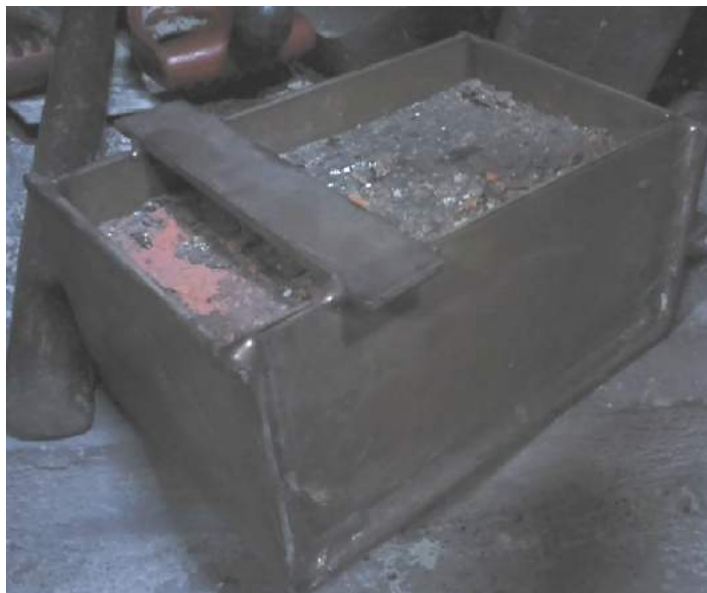
Figura 20 – Foto do banho de chumbo utilizado para transformação isotérmica bainítica
