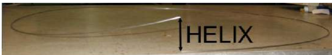
Figura 4. 4 - Medição do helix de acordo com a norma SFA-5.18.
