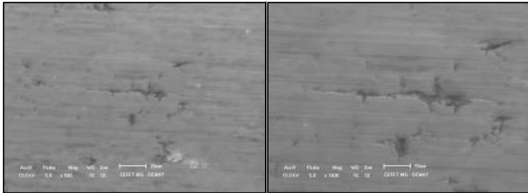
Figura 5. 21 - Superfície do arame com feira semiângulo 9° CP
