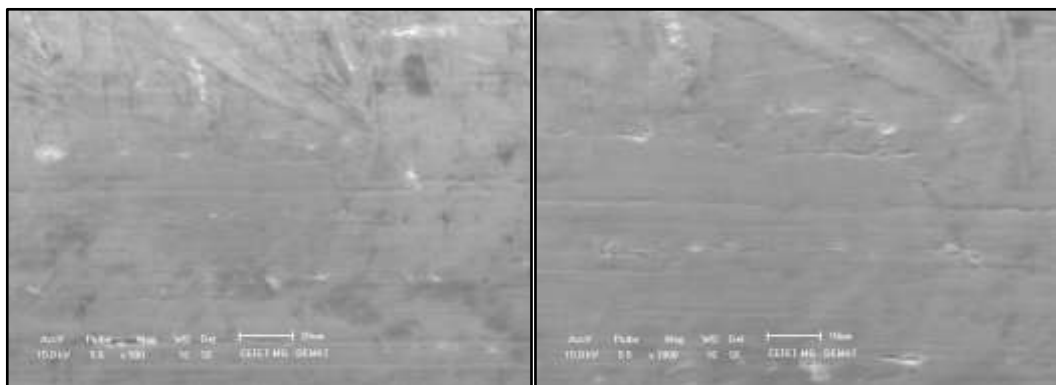
Figura 5. 23 - Superfície do arame com feira semiângulo 14° CP
