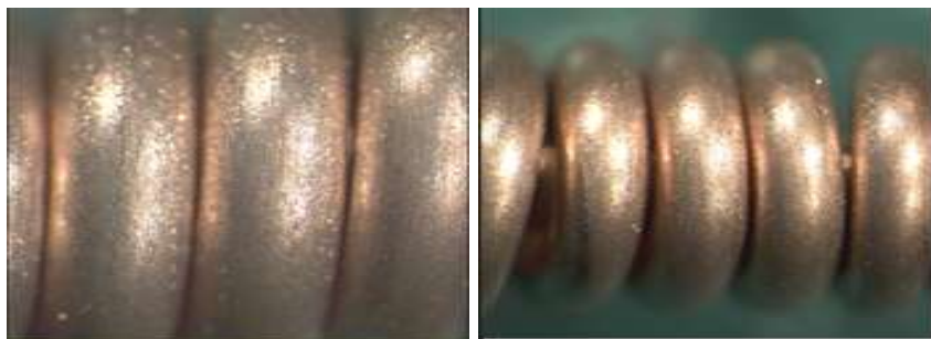
Figura 5. 26 - Aderência do arame com fieira semiângulo 6°
