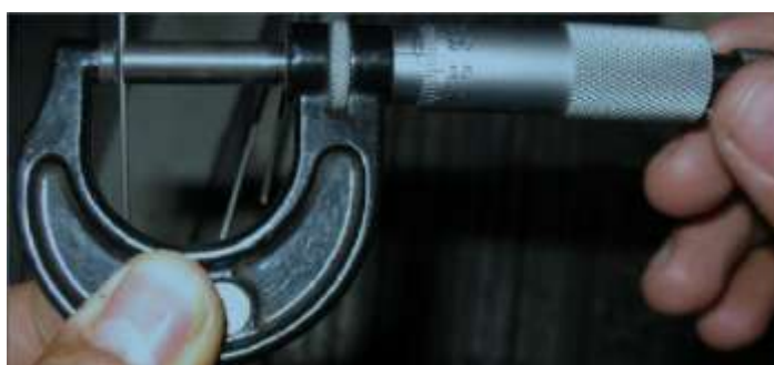
Figura 4. 2 – Forma de medir o diâmetro real do arame conforme norma AWS SFA-5.19.
