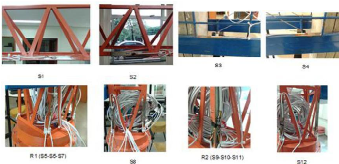
Figura 37 - Extensômetros colados na Grua (próprio autor)
