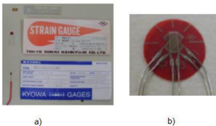
Figura 39 - a) Terminal KYOWA-TF-2, e extensômetros: TML-FRA-2-11, KYOWA-KFG-1-120-C1-11L1M2R (GALO, 2014) e b) Composição da Roseta, TML - FRA-2-11 (GALO, 2014)
