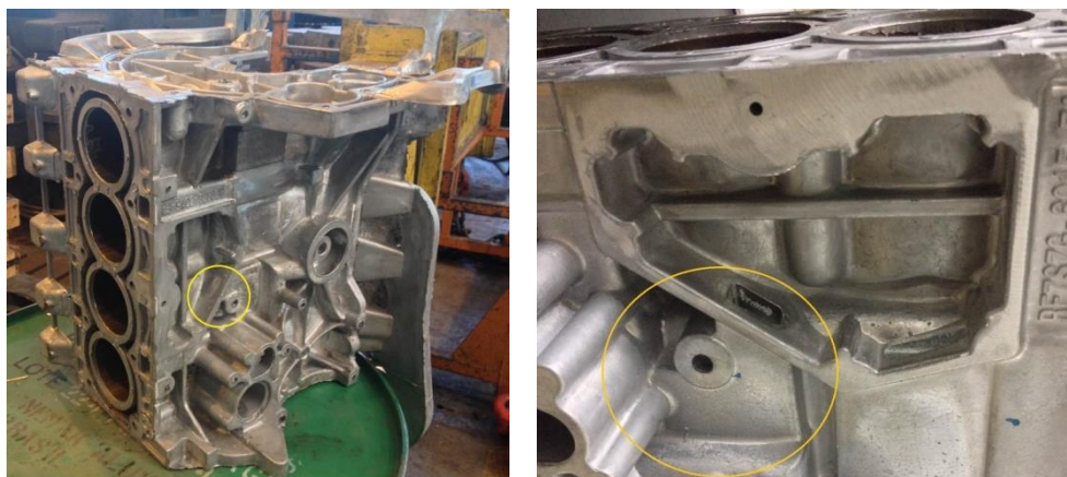
Figura 44 - Bloco de Alumínio após fundição e após semiacabamento com rebarbador.
