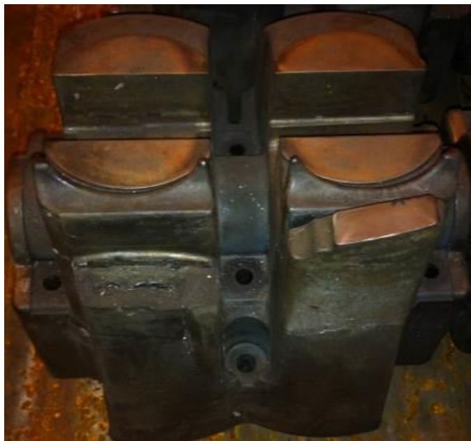
Figura 22 – Exemplo: Postiço da matriz fixa ferramental nº 10 quebrado após 5.500 ciclos.
