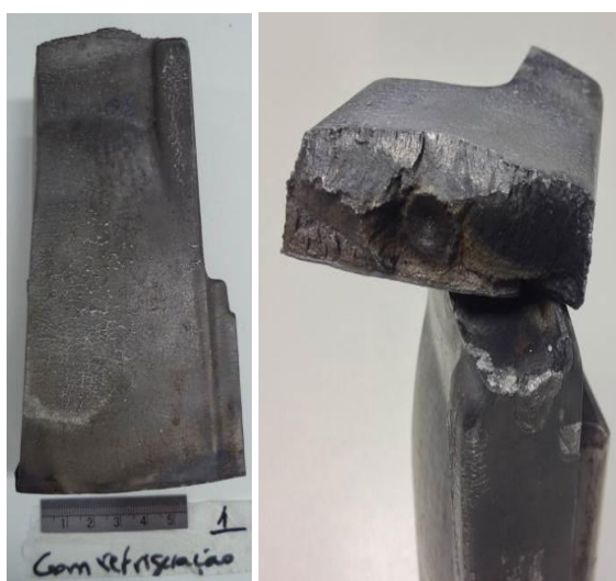
Figura 53 - Inseto quebrado após 3.000 ciclos no ferramental nº 11 amostra 1.
