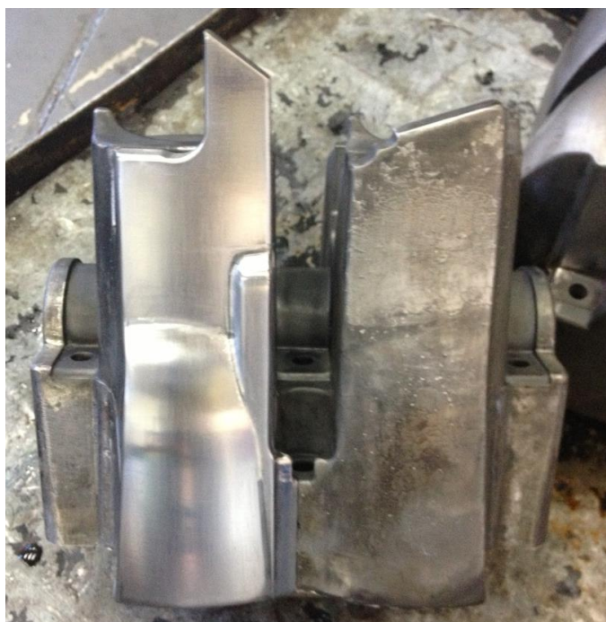
Figura 36 - Inserto ajustado e polido no posticho usado.
