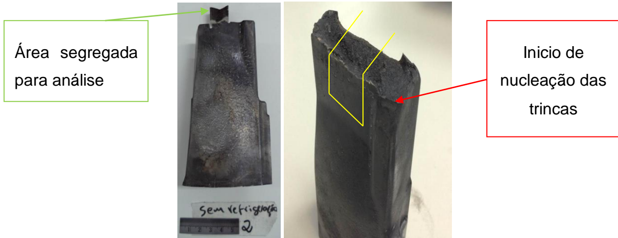
Figura 54 - Inseto quebrado após 17.000 ciclos no ferramental nº 10, amostra 2.
