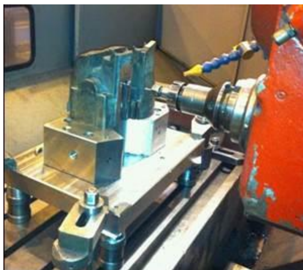
Figura 30 - Postigo da matriz fixa usinado com rabo de andorinha.
