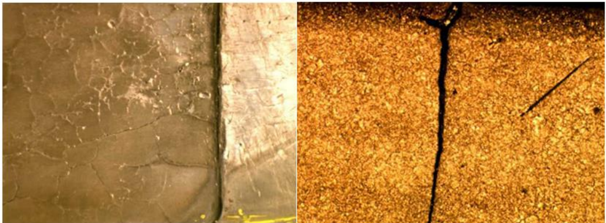
*Figura 6 - Dano típico causado por fadiga térmica.
