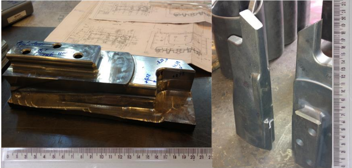
Figura 31 - Inserto do postigo central usinado e após a usinagem.
