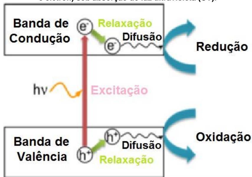
Figura 10 – Ilustração esquemática da formação dos portadores de carga foto gerados (buraco e elétron) sob absorção de luz ultravioleta (UV).
