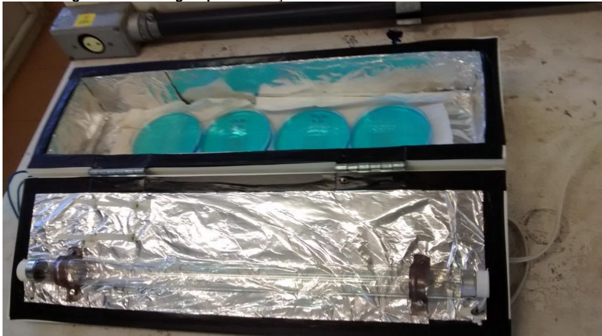
Figura 28 – Montagem para avaliação da atividade fotocatalítica dos filmes.
