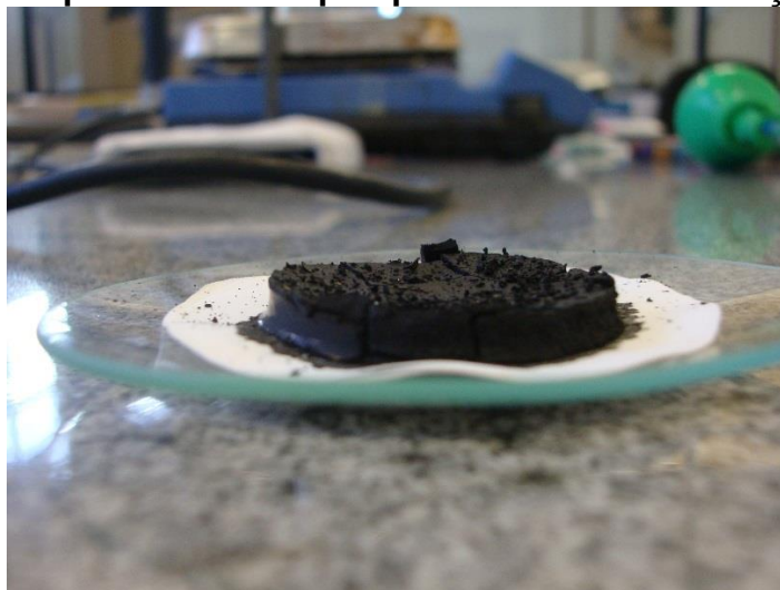
Figura 15 – Precipitado obtido após procedimento de filtração e secagem
