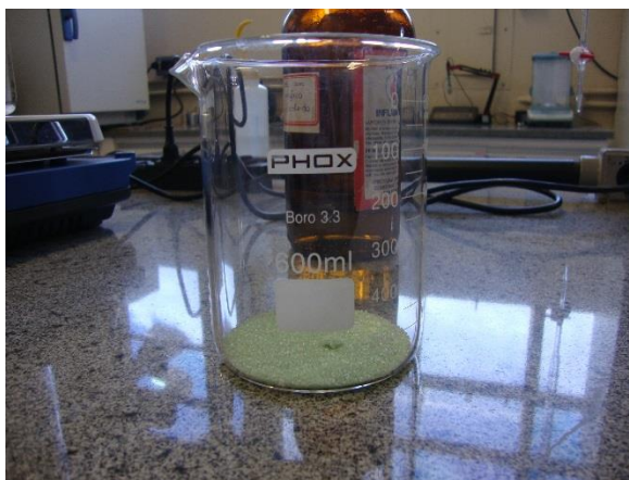
Figura 10 – Solução 01 preparada a partir da adição de cerca de 16g de \text{FeSO}_4 \cdot 7\text{H}_2\text{O} em 112mL de água destilada
