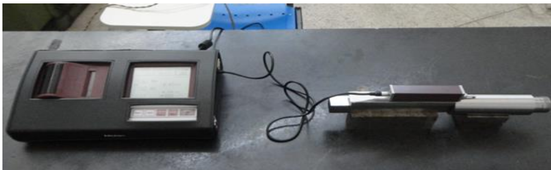
Figura 24 - Medição dos parâmetros de rugosidade.
