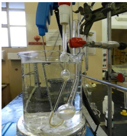
Figura 20 - Sistema montado para manter a temperatura a 40°C.
