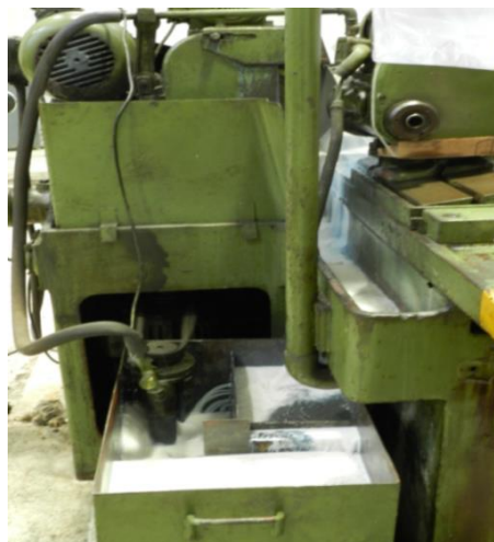
Figura 14 - Reservatório da retificadora com seus três compartimentos e bomba.
