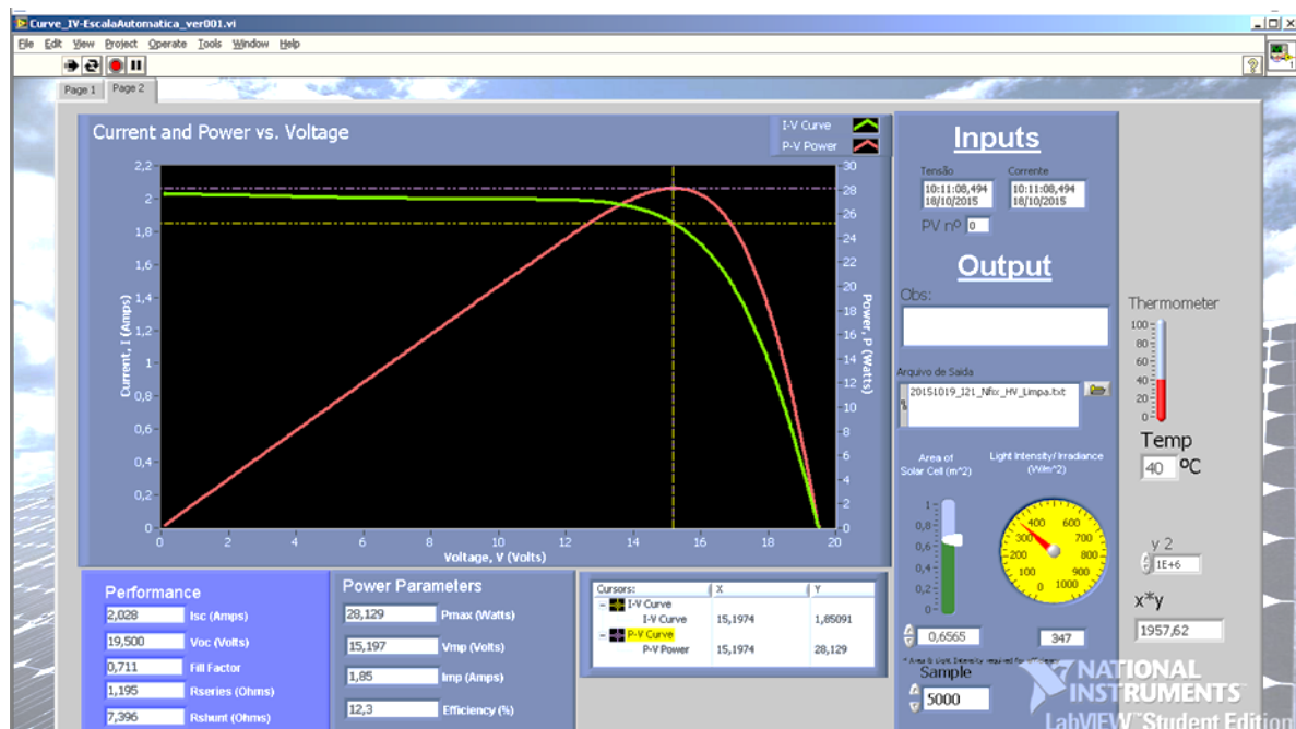
b) Tela 2 - Curva de Corrente x Tensão, Potência x Tensão e cálculo de parâmetros
