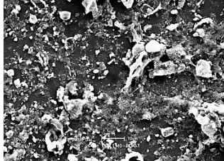
Figura 61 - Análise 2 – (a) MEV e a composição elemental (b) Espectro de EDS
