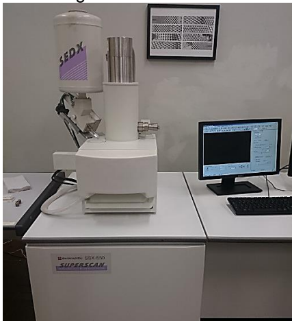
(a) Microscópio Eletrônico de Varredura da SHIMADZU modelo SSX-550 SUPERSCAN.
