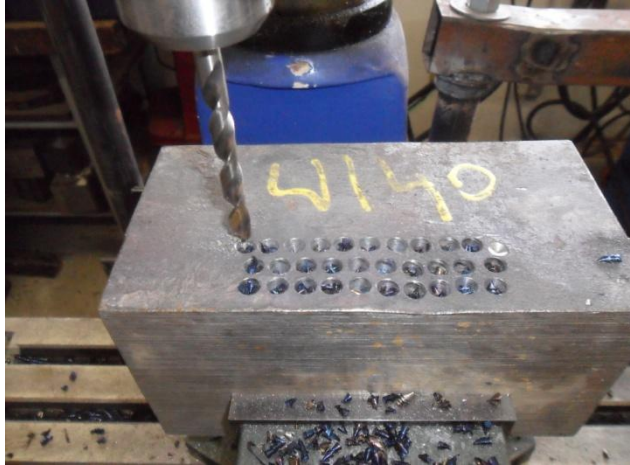
Figura 44 Detalhamento dos furos na amostra
