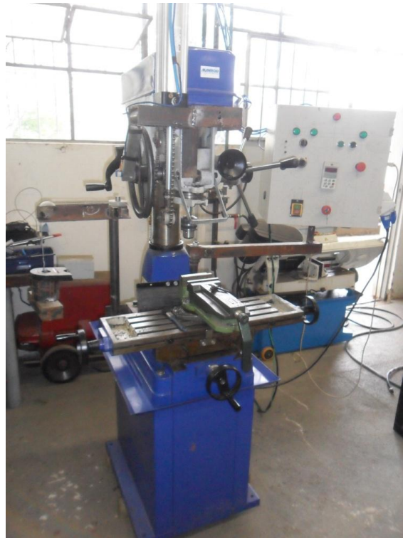
Figura 38 Equipamento para ensaio de furação a pressão constante
