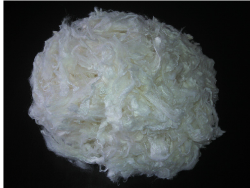
Figura 12 - Fibra de bambu modificada quimicamente.
