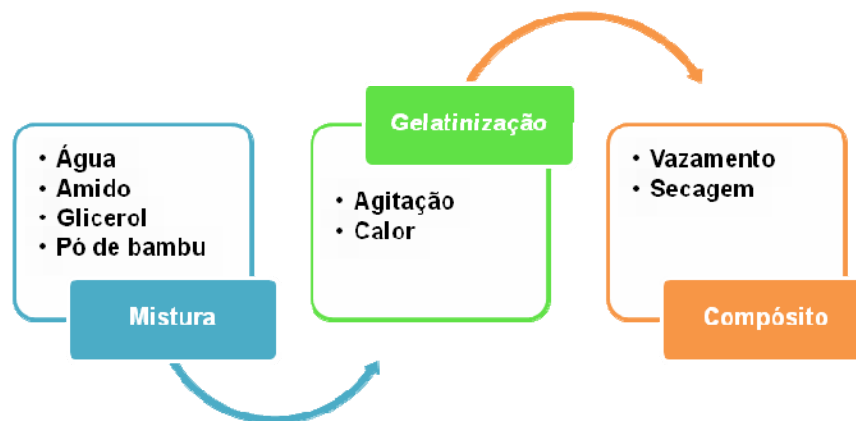
Esquema 3 – Fluxograma do processo de obtenção do compósito amido-bambu.
