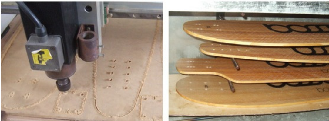
Figura 14 - O uso de compósito de resina epóxi, fibra de vidro e bambu para fabricação de pranchas
