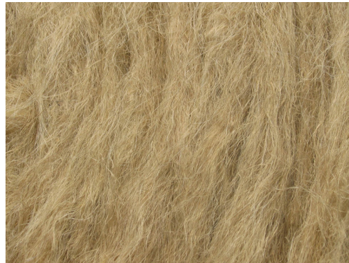
Figura 13 - Fibra de bambu modificada mecanicamente
