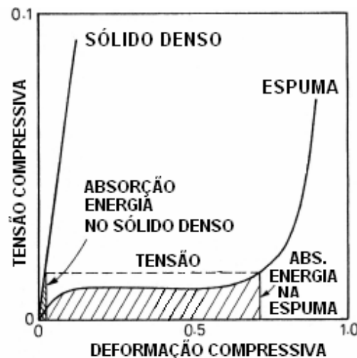
Figura 6 Curva de compressão versus deformação de material denso e espuma
