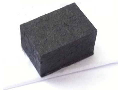
Figura 4.4 – Representação e imagem, como exemplo, da amostra de aço ferramenta levada à caracterização mecânica e microestrutural.
