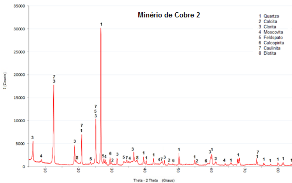
Figura 8 – Identificação das fases no difratograma da amostra de minério de cobre 2
