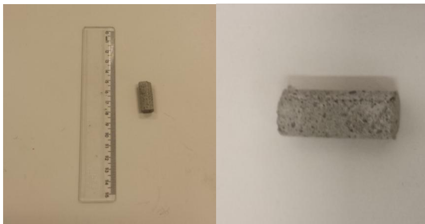
Figura 4.12 – Corpo de prova utilizado no ensaio de dilatação térmica.
