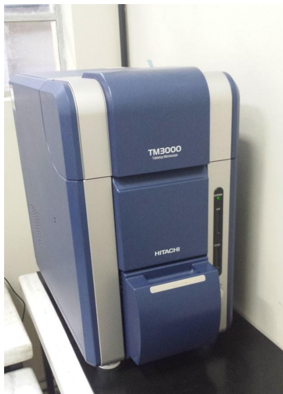
Figura 4.5 – Equipamento TM3000 utilizado nos ensaios de microscopia eletrônica de varredura.
