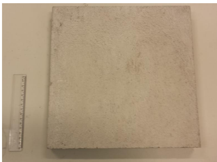
Figura 4.15 – Corpo de prova utilizado no ensaio de condutividade térmica.
