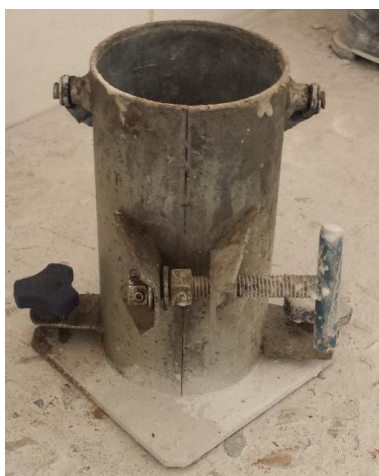
Figura 4.7 – Forma metálica cilíndrica usada para confeccionar as amostras dos ensaios de resistência à compressão e módulo de elasticidade.
