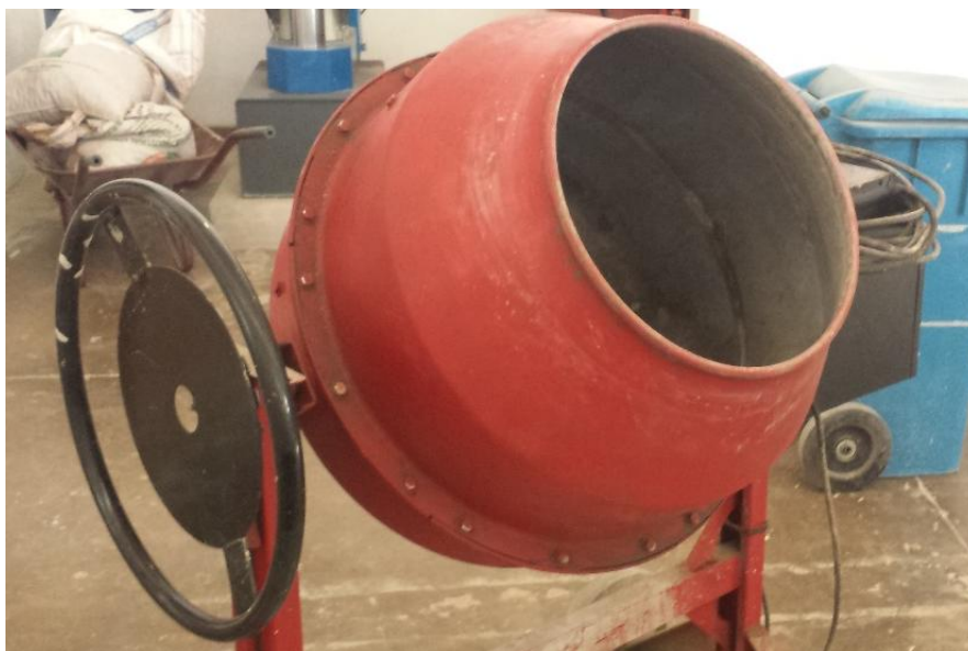
Figura 4.4 – Betoneira usada para mistura do concreto das amostras ensaiadas nesse trabalho.
