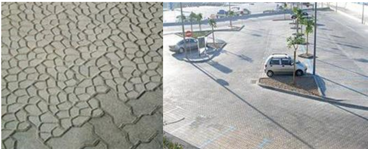
Figura 9 - Arranjos de pavimento intertravado. Fonte: Uni-stein, 2007 e Soplacas, 2007.
