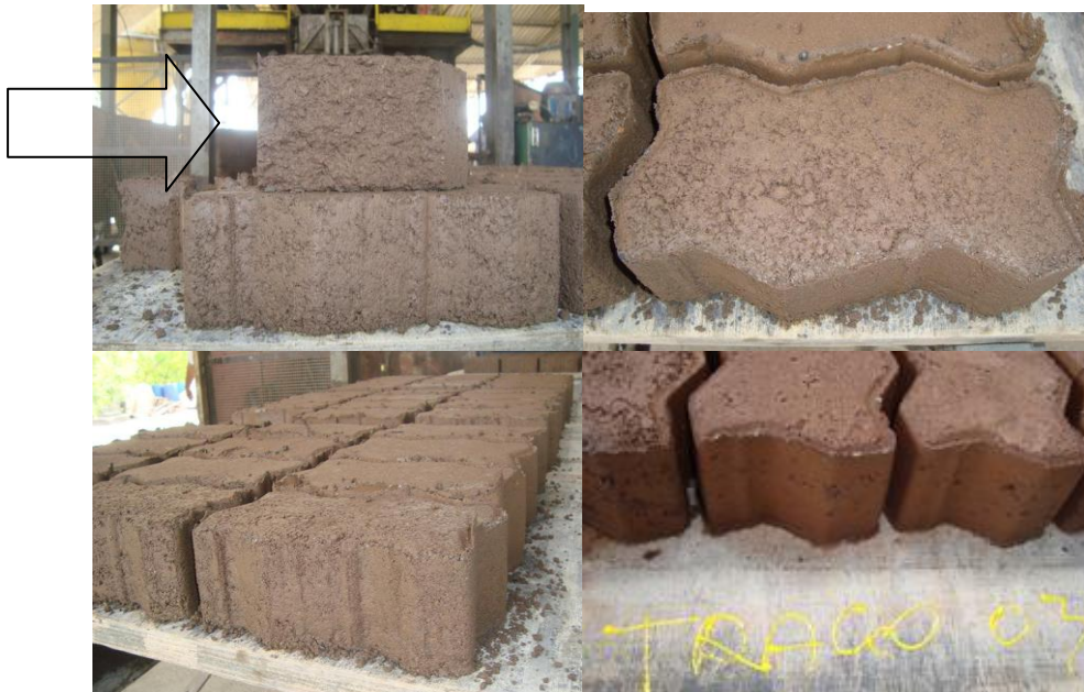
Figura 32 – Aspectos superficiais dos blocos e detalhes internos na secção transversal (seta indica superfície da fratura) mostrando compactação do bloco.
