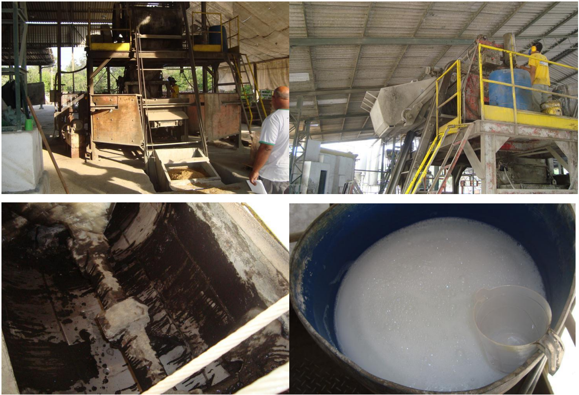
Figura 28 - Sistema de alimentação do misturador, abastecimento de materiais na vibroprensa e aspecto do aditivo utilizado na fabricação de elementos para pavimentação - Pedro Leopoldo (MG).
