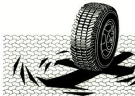
Figura 18 - Pressão sobre o pavimento PAVI-S e sua redistribuição de forças. Fonte: Uni-stein, 2007.
