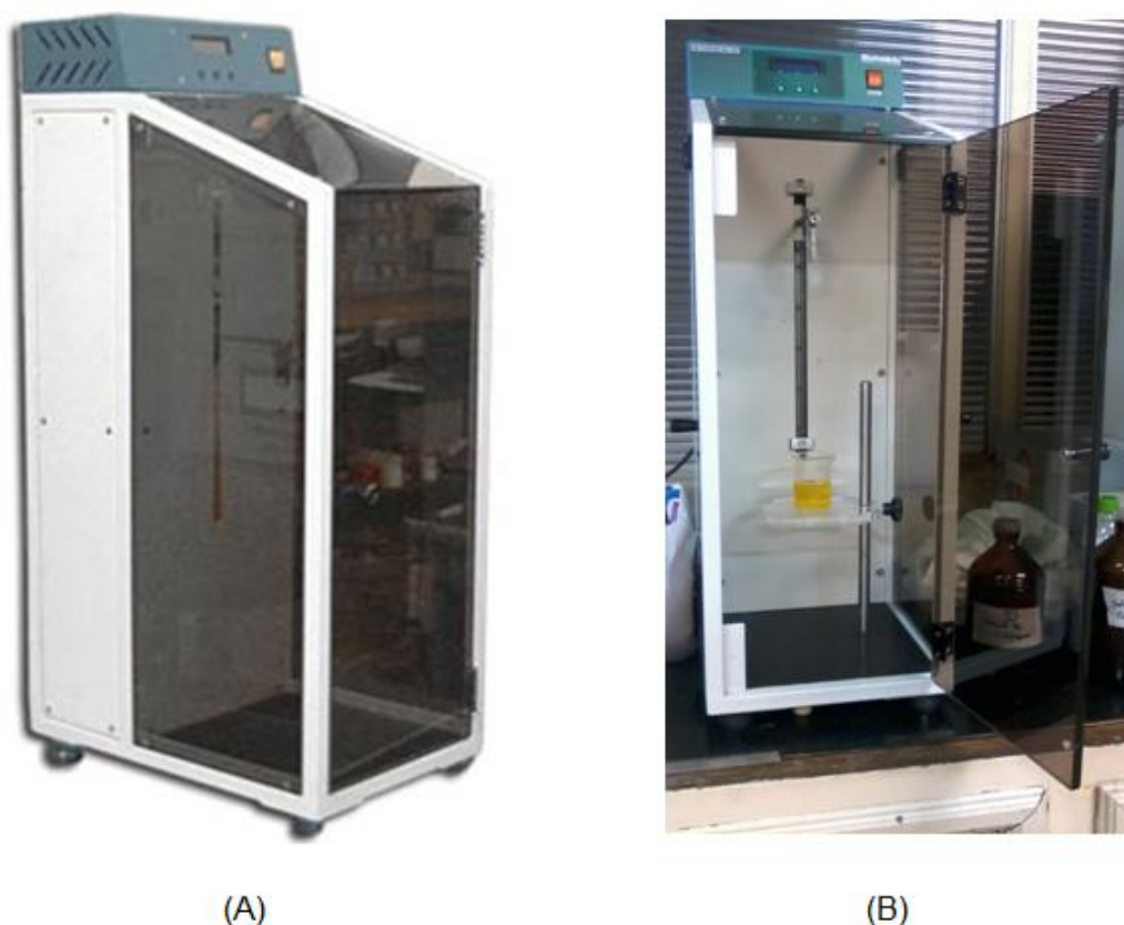
Figura 20 - Dip coater: modelo MA 765: a) Equipamento fechado; b) Equipamento aberto
