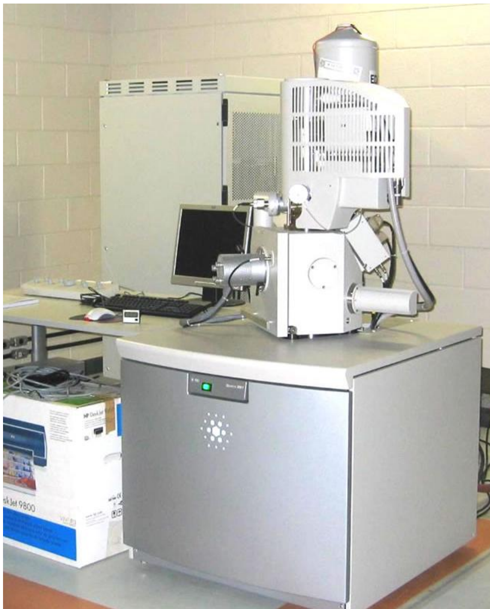
Figura 25 - Microscópio eletrônico de varredura Quanta 200 da FEI Centro de Microscopia da UFMG.
