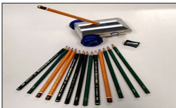
Figura 13- Aparelho para teste de dureza a lápis.
