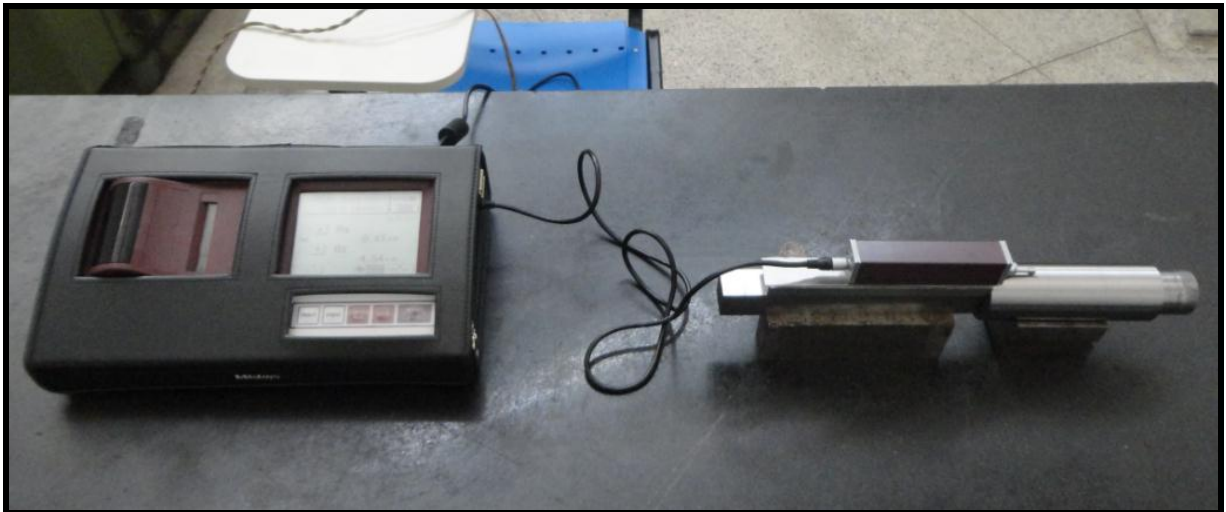
Figura 26: Medição dos parâmetros de rugosidade
