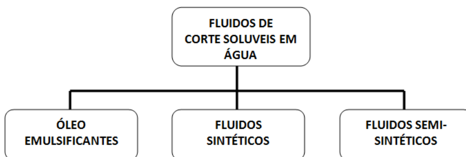
Figura 17: Classificação dos Fluidos de corte solúveis em água Fonte: EL BARADIE, 1996a (adaptada).
