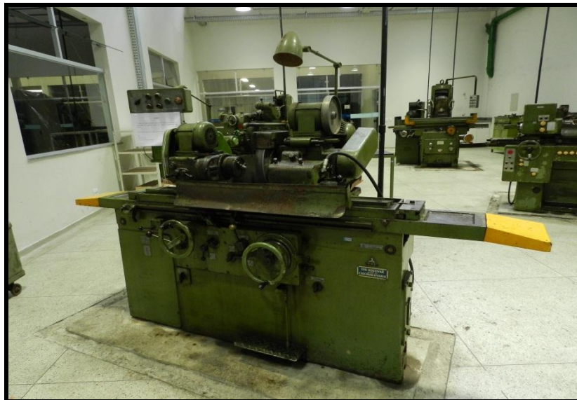
Figura 19: Laboratório de retificação e retificadora cilíndrica universal utilizada nos experimentos
