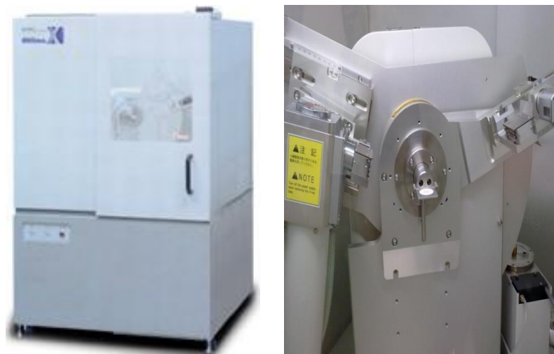
Figura 5. 3 - Difratômetro de raios x com destaque para o porta amostra
