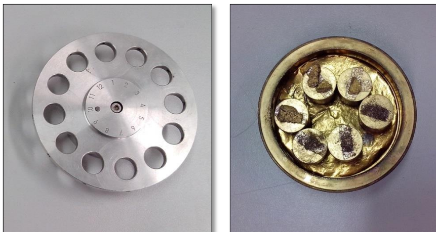
Figura 18 - Porta amostras e amostras metalizadas
