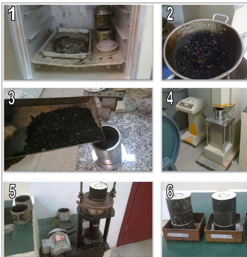
Figura 19 - Moldagem dos CPs Marshall
