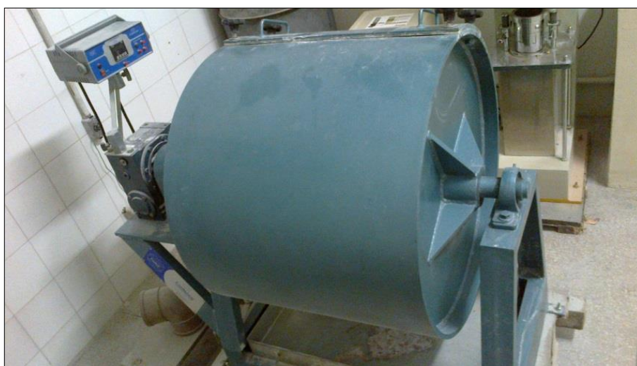
Figura 24 - Máquina de abrasão Los Angeles
