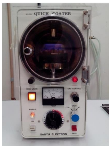
Figura 17 - Quick coater: Metalização
