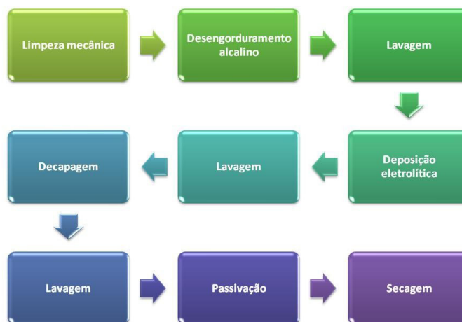
Figura 17 - Fluxograma do processo de preparação das amostras para deposição eletrolítica
