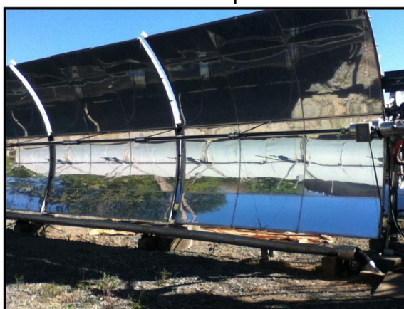
Figura 11 - Concentrador solar cilíndrico parabólico instalado no CEFET-MG
