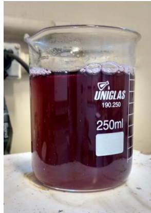
Figura 18 - Solução resultante da lixiviação do catodo da bateria
