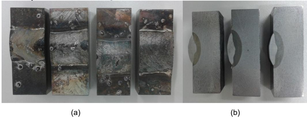
(a) Corpo de prova soldado após o corte; (b) Amostras produzidas a serem caracterizadas.
