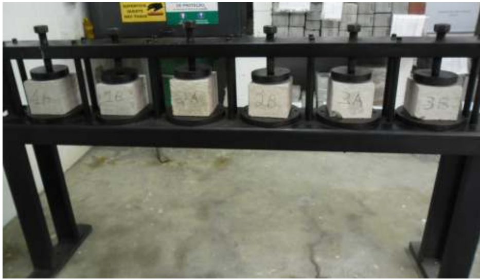
Figura 12 - Ensaio de penetração de água sob pressão realizada nos corpos de prova dos concretos
