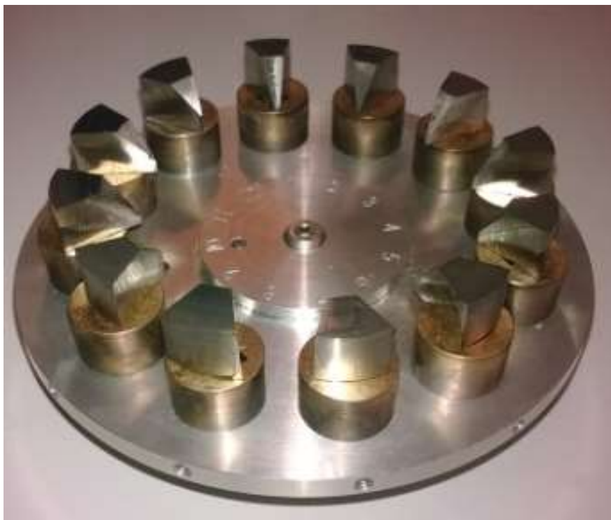
Figura 19 - Corpos de prova fixados no dispositivo do Microscópio Eletrônico de Varredura.
