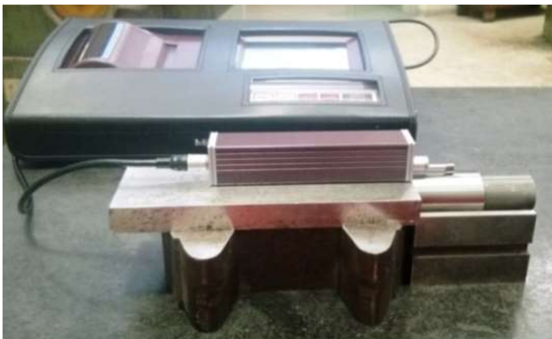
Figura 17 - Montagem para medição da rugosidade.
