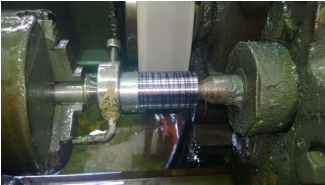
Figura 16 - Procedimento para avaliação do desgaste do rebolo.
