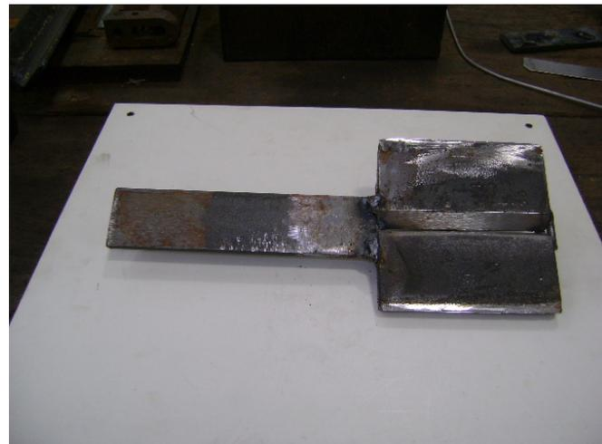
**FIGURA 4.4 – Montagem do apêndice no corpo de prova**
