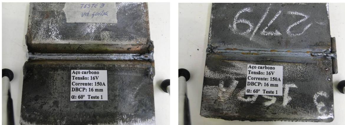
**FIGURA 5.3 – Aparência do cordão de solda para a condição de soldagem: 150 A, 16V, DBCP de 16 mm, ângulo de soldagem 60°**
