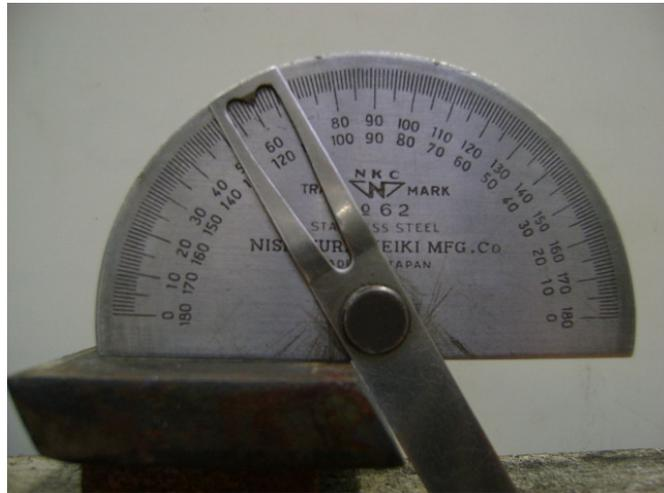
**FIGURA 4.2 – Preparação do bisel com ângulo de 30 graus em relação a perpendicular**
