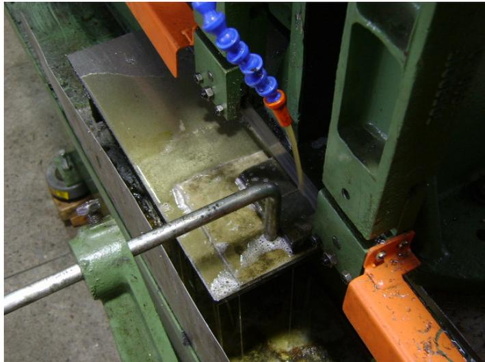
**FIGURA 4.6 – Corte longitudinal ao passe de raiz efetivado na serra de fita refrigerada**
