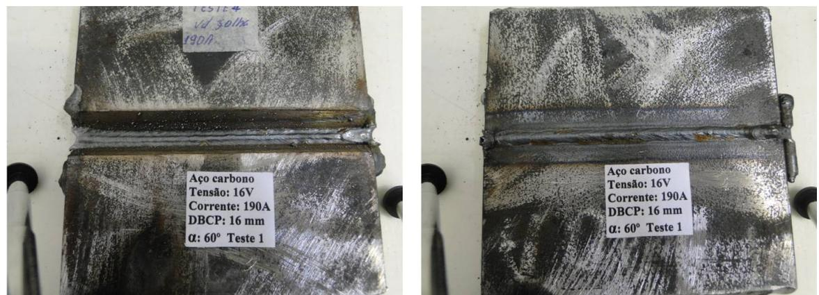
**FIGURA 5.7 – Aparência do cordão de solda para a condição de soldagem: 190 A, 16V, DBCP de 16 mm, ângulo de soldagem 60°**
