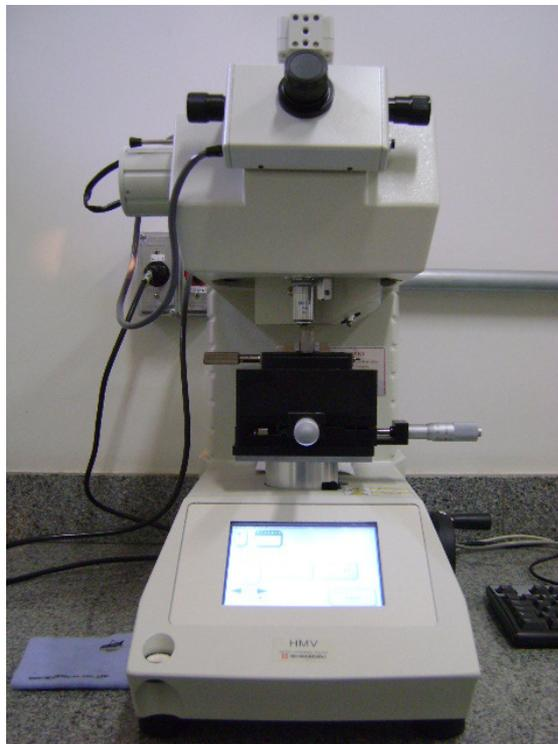
**FIGURA 4.9 – Aparelho utilizado para medição da microdureza**
