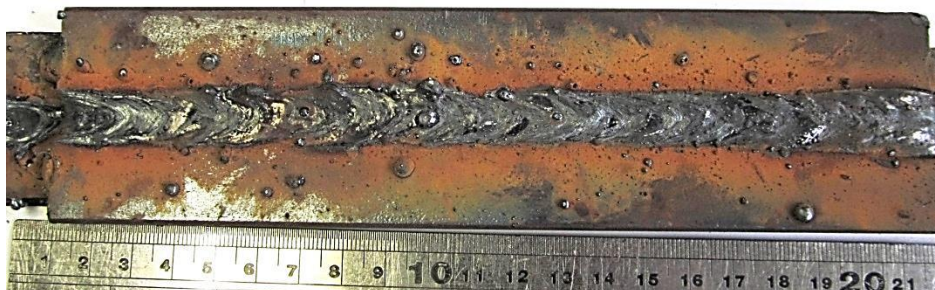
Figura 39 – Cordão de solda com escória produzido com arame 5% com proteção gasosa.
