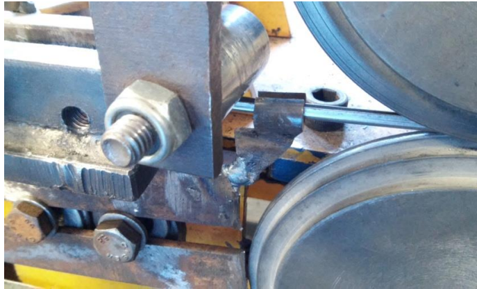
Figura 24 – Guia construída e instalada antes do rolete de fechamento do arame
