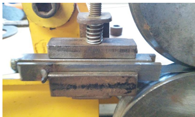
Figura 23 – Guia construída e instalada antes do rolete de dobramento da fita
