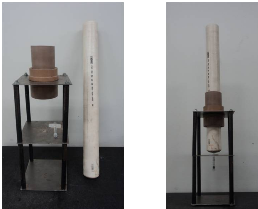
Figura 13 - Dispositivo de injetabilidade (a) - visão anterior do dispositivo de injetabilidade mostrando o suporte, o êmbolo oco e a seringa. (b) dispositivo de injetabilidade montado com todos os seus componentes.
