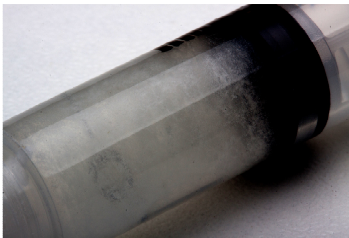
Figura 19 – Separação das fases do compósito (AH gel/BCP microesferas)
