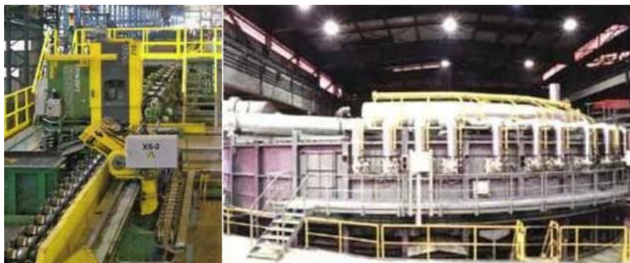
Figura 3.1– Principais etapas do processo de laminação de tubos: (a) Preparação de barras;(b) Forno de aquecimento.
