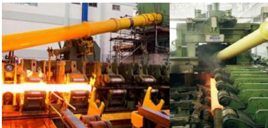
Figura 3.2– Principais etapas do processo de laminação de tubos: (a) Vista lateral do laminador CTP; (b) Vista frontal .
