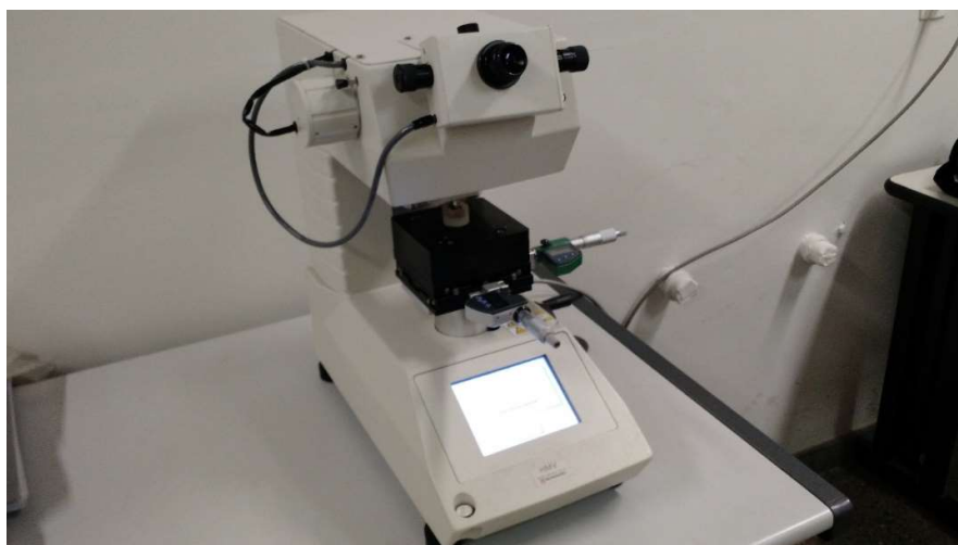
Figura 48 – Microdurômetro Micro Hardness Tester HMV-2, marca Shimadzu.
