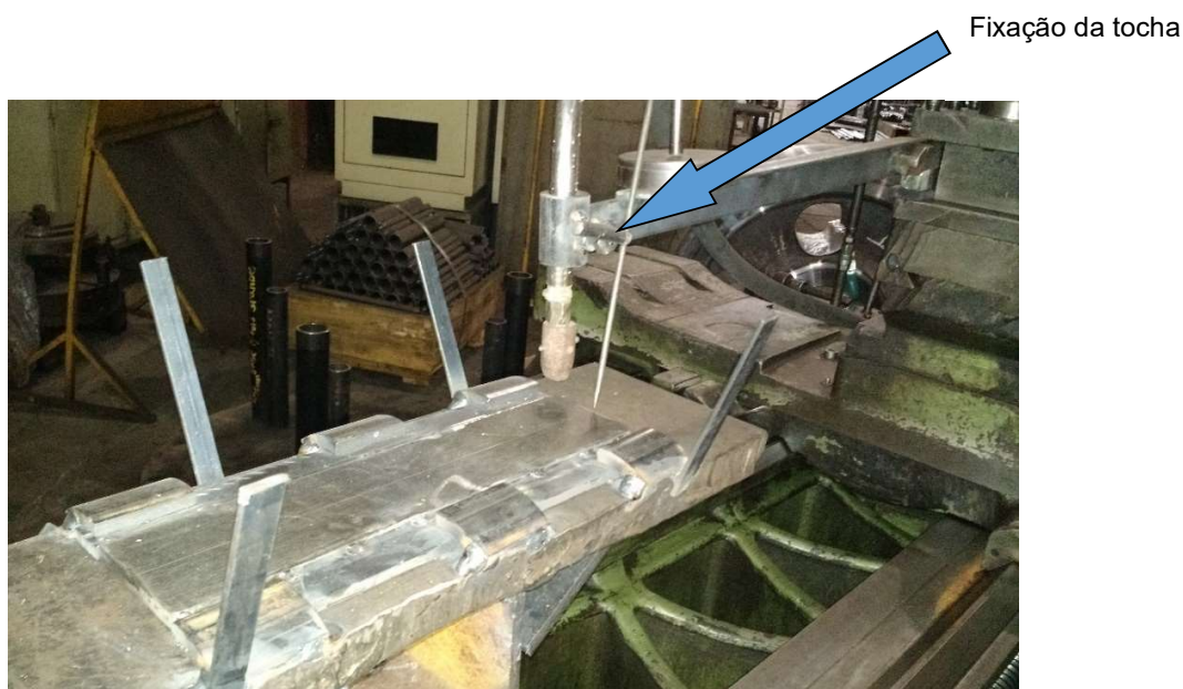
Figura 41 – Dispositivo de soldagem.
