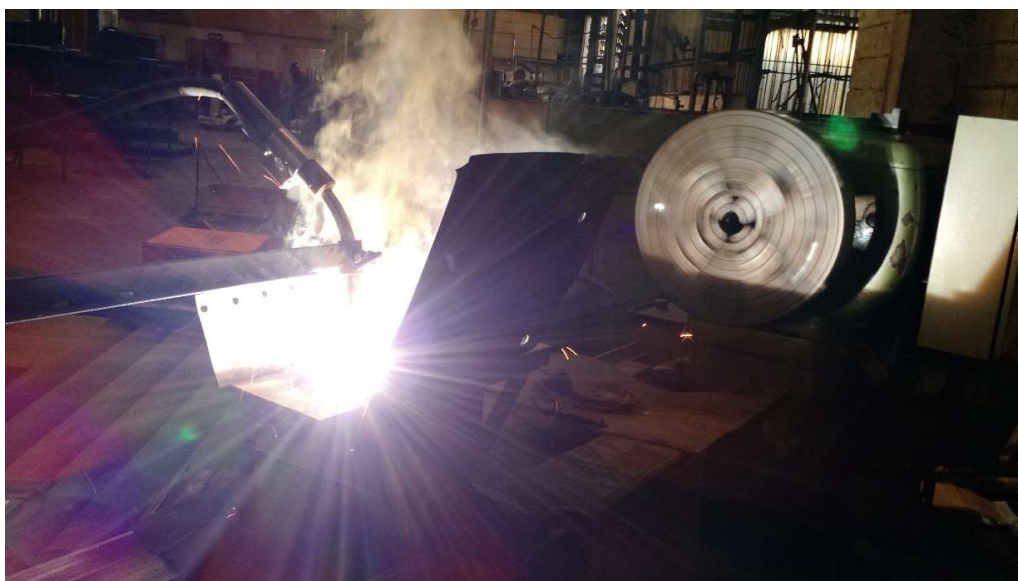
Figura 42 – Soldagem da chapa de teste.
