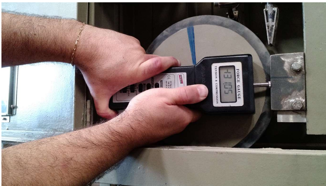
Figura 34 – Medição da carga de ensaio.
