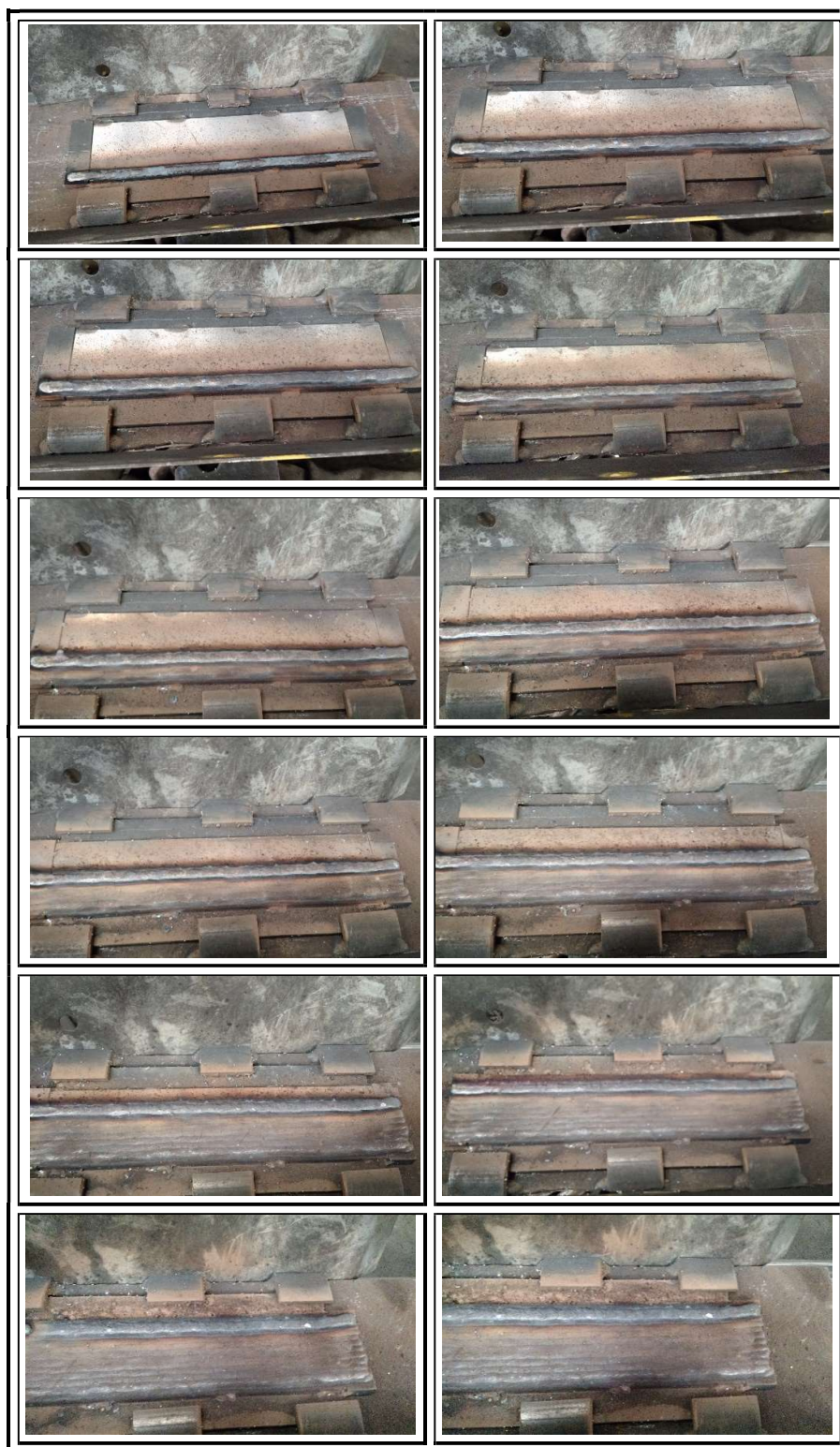
Figura 43 – Sequência de soldagem das chapas de teste.
