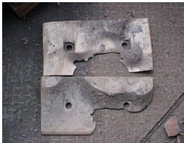
Figura 4 - Condições da placa de desgaste após 15 dias de operação
