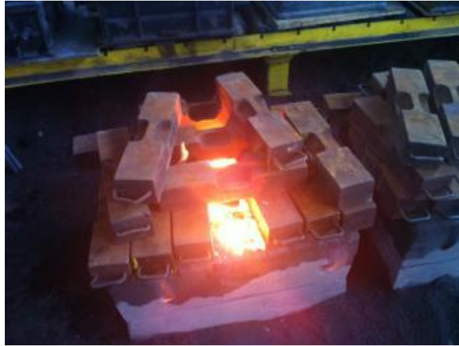
Figura 44 – Preenchimento do molde da placa de desgaste.
