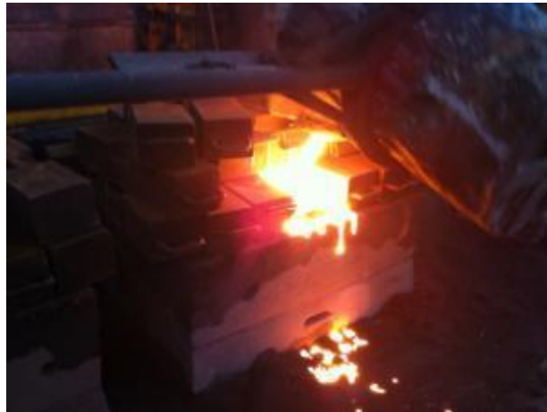
Figura 38 – Preenchimento do molde da placa de desgaste.
