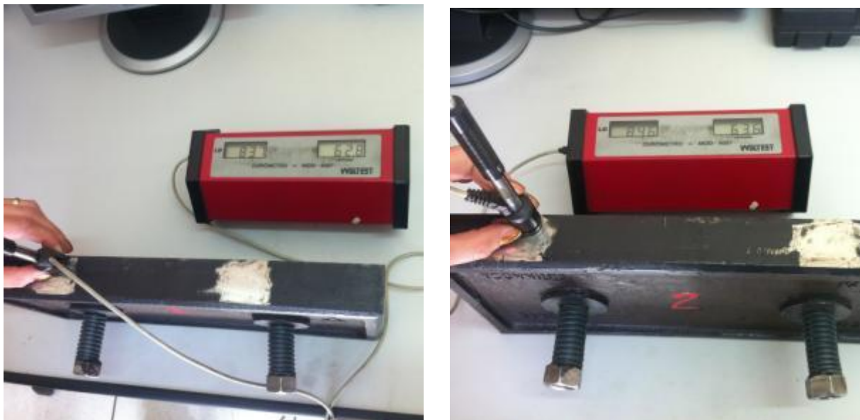
Figura 101 - Medição da dureza ao longo da espessura da placa de desgaste tratada termicamente.
