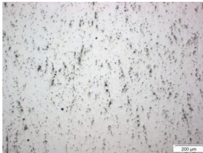
Figura 66 - Microestrutura do Ferro Fundido Branco Alto Cromo com 1,6% Nb (Liga 3) com tratamento térmico e sem ataque químico.
