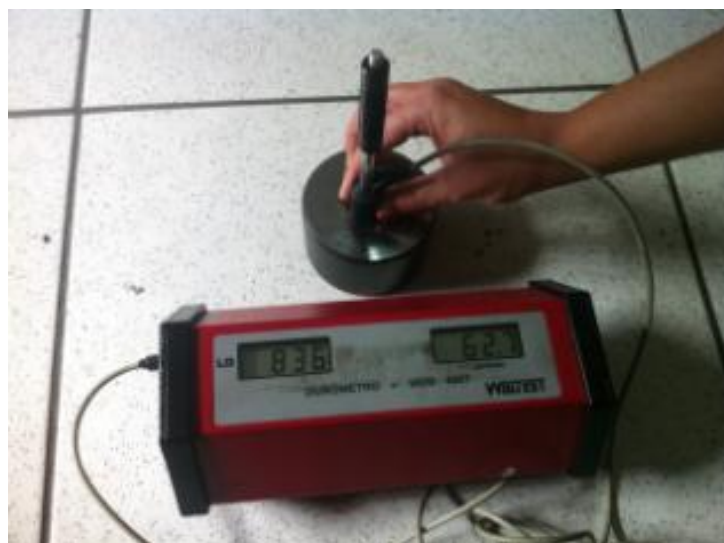
Figura 100 – Calibração do durômetro com bloco padrão para medição na escala Rockwell C.
