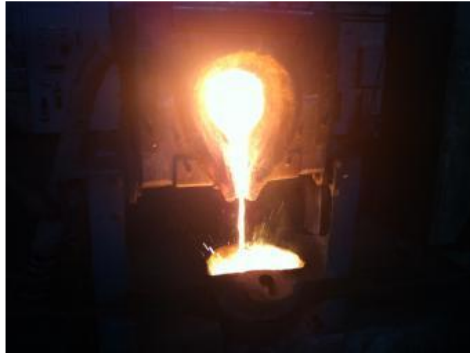
Figura 40 – Vazamento da Liga 3 com 1,66% Nb.
