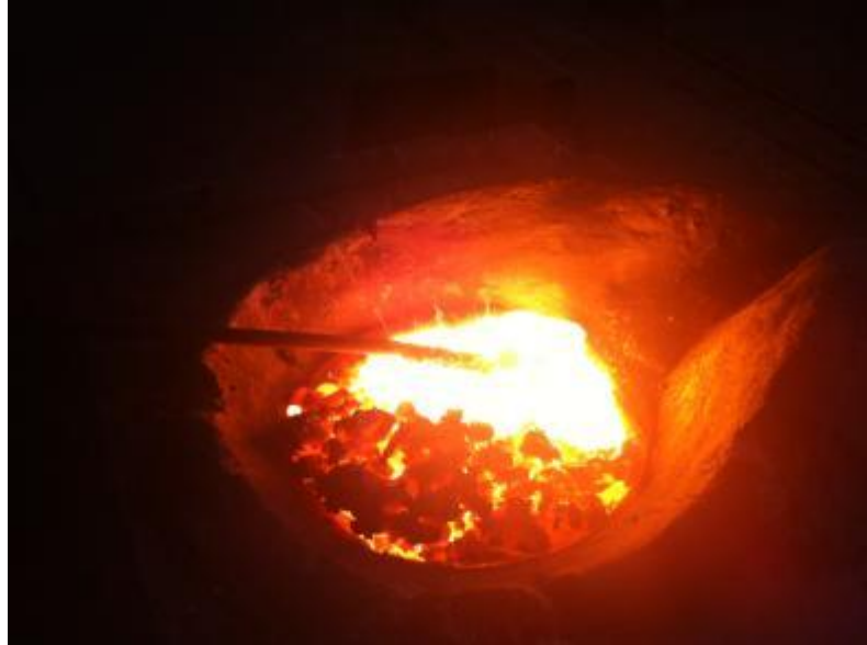
Figura 33 – Adição de escorificante no banho líquido
