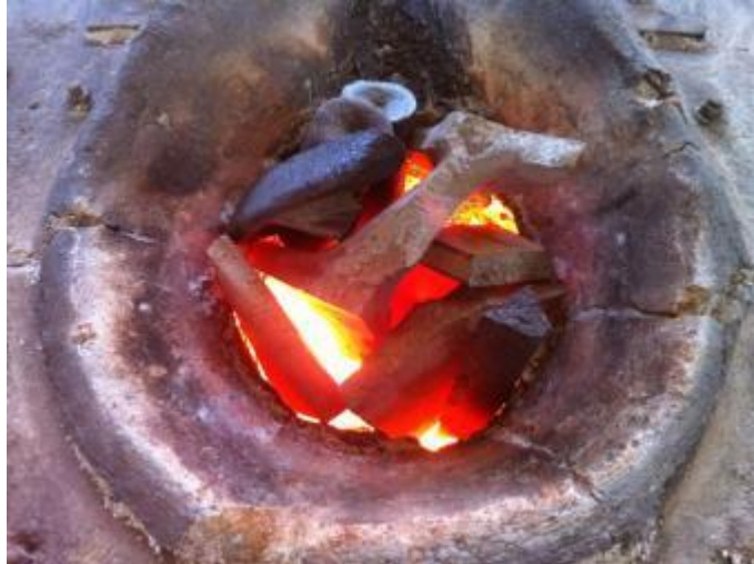
Figura 29 – Alimentação do cadinho e fusão da carga base.
