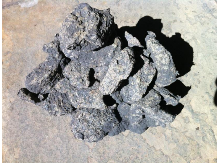
Figura 42 – Ferro Nióbio não dissolvido retirado do fundo do cadinho
