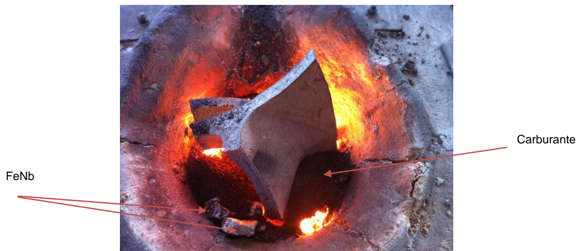
Figura 32 – Adição de FeNb e carburante.
