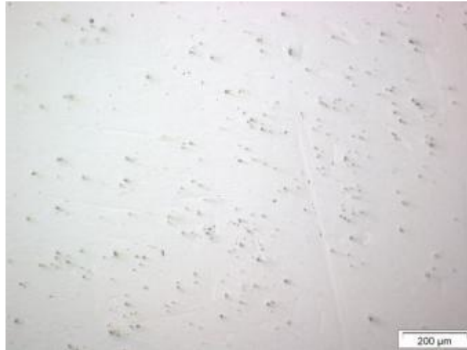
Figura 58 - Microestrutura do Ferro Fundido Branco Alto Cromo (Liga 1) com tratamento térmico e sem ataque químico.
