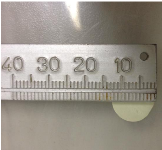
Figura 11 – Medida do diâmetro do corpo de prova
