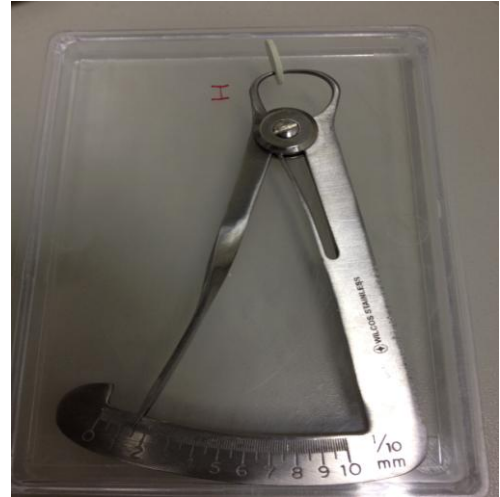
Figura 12 – Medida da espessura do corpo de prova
