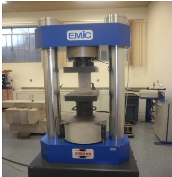
Figura 28- Prensa Hidráulica para ensaio de resistência à compressão Fonte: Foto do autor
