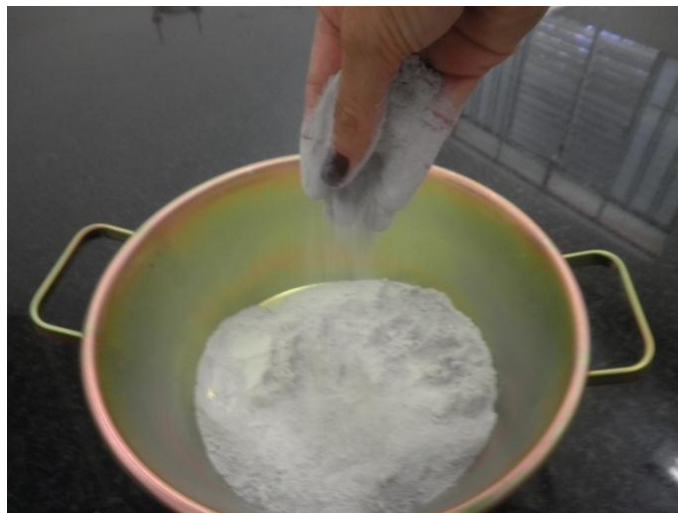
Figura 23- Resíduo da casca cerâmica pulverizado Fonte: Foto do autor
