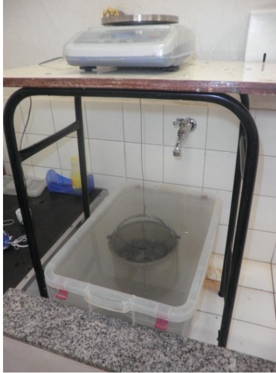
Figura 20- Determinação da massa submersa Fonte: Foto do autor
