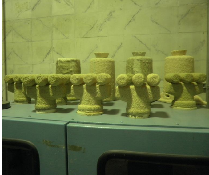
Figura 5- Moldes cerâmicos não calcinados do processo de microfusão Fonte: Foto do autor
