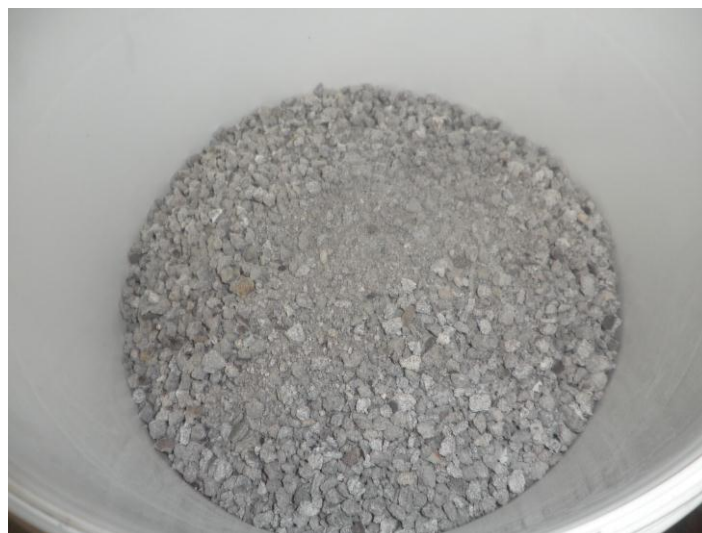
Figura 22- Fragmentos do resíduo da casca cerâmica após do processo de britagem Fonte: Foto do autor
