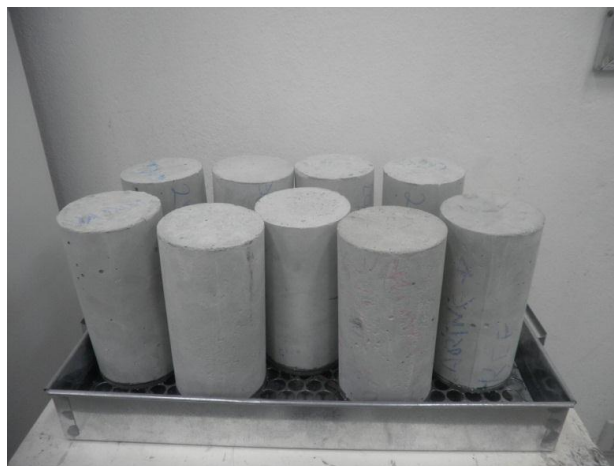
Figura 30- Ensaio de absorção de água por capilaridade Fonte: Foto do autor
