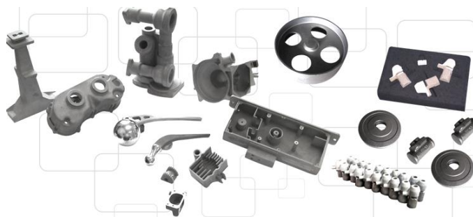
Figura 3- Peças produzidas pelo processo de fundição por cera perdida Fonte: ABIFA (2011)
