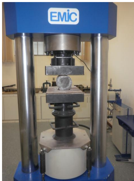
Figura 29- Ensaio para determinação da resistência à tração por compressão diametral Fonte: Foto do autor
