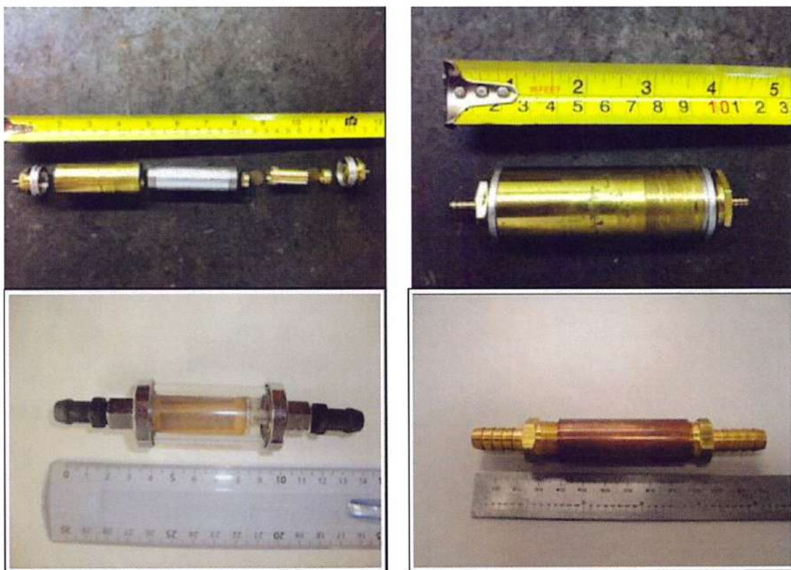
Figura 1 - Catalisadores concebidos para serem instalados diretamente no motor de ciclo Otto. Fonte: Imagens do autor
