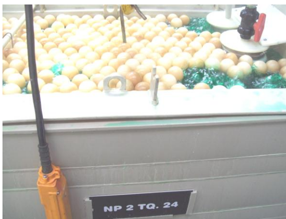
Figura 39 - Tanque de deposição de NP2, alto fósforo.
