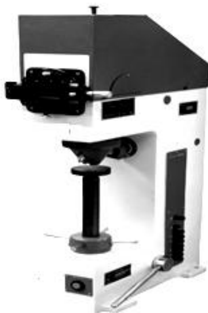
Figura 25 - Durômetro para ensaio de dureza com ponteira de diamante.
