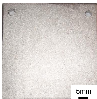
Figura 40 - Amostra NP2 após deposição química de NiP
