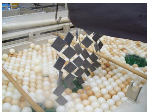
Figura 37 - Amostras enganchadas para deposição de NiP.
