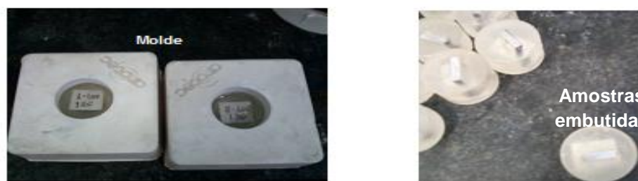
Figura 44 - a) Molde emborrachado, b) Amostras embutidas
