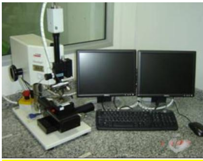
Figura 52 - A instrumentação do ensaio de riscamento REVETEST CSEM – CETEC-FIEMG.
