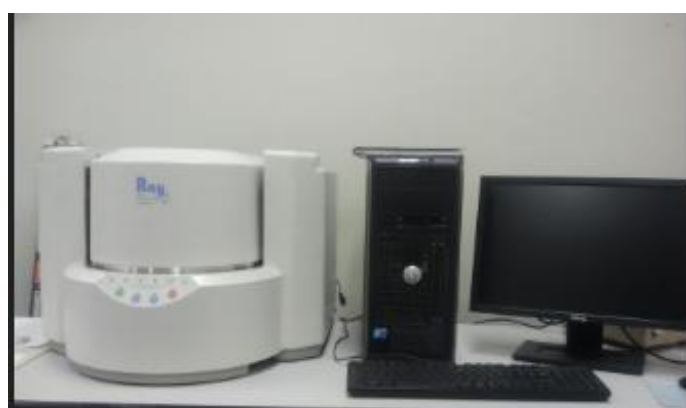
Figura 41 - Equipamento de fluorescência, modelo EDX 720, Marca Shimadzu.
