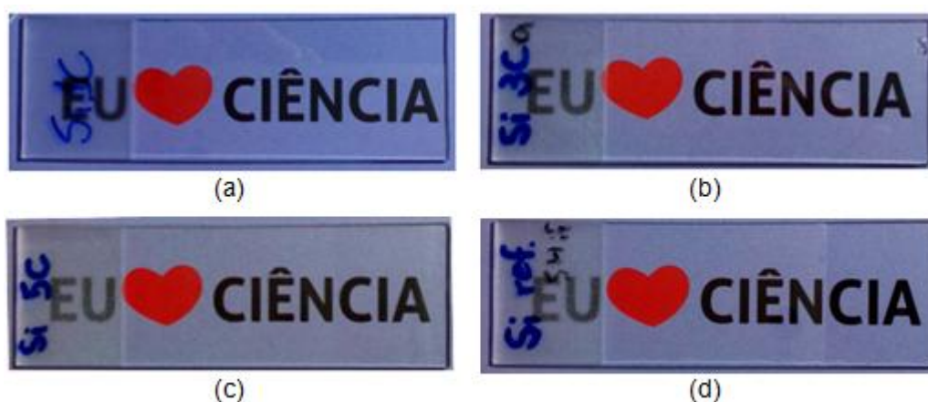
Figura 40 – Filmes finos de Sílica: (a) 1 camada de SiO 2 ; (b) 3 camadas de SiO 2 ; (c) 5 camadas de SiO 2 ; (d) vidro de referência
