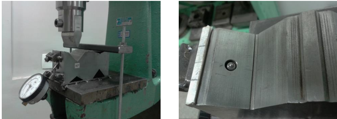
Figura 4.17 - Sistema de fixação do relógio comparador à matriz.
