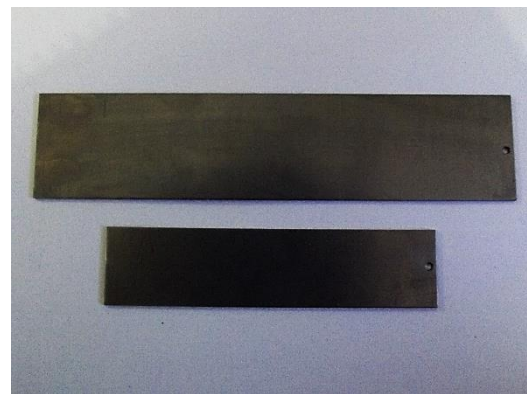
Figura 4.6 - Amostras para os tratamentos térmicos para confecção dos corpos de prova.
