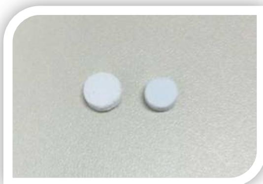
Na Figura 41 a peça com maior contração de bordas foi sinterizada a 1300°C. A Tabela 7 mostra medidas realizadas em 9 peças distintas sinterizadas nas temperaturas de 1200 e 1300°C.
