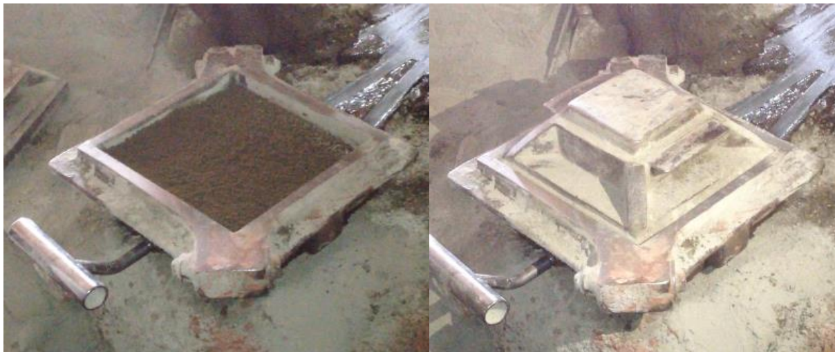
Figura 13: Adição cimento e areia lavada e acréscimo do tampão para prensagem
