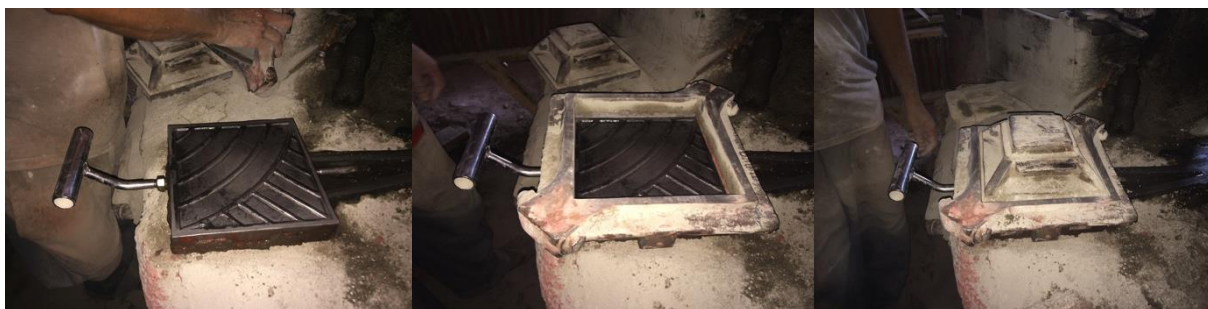
Figura 11: Peças que compõem a forma de ferro para ladrilho (prato, quadro e tampão)
