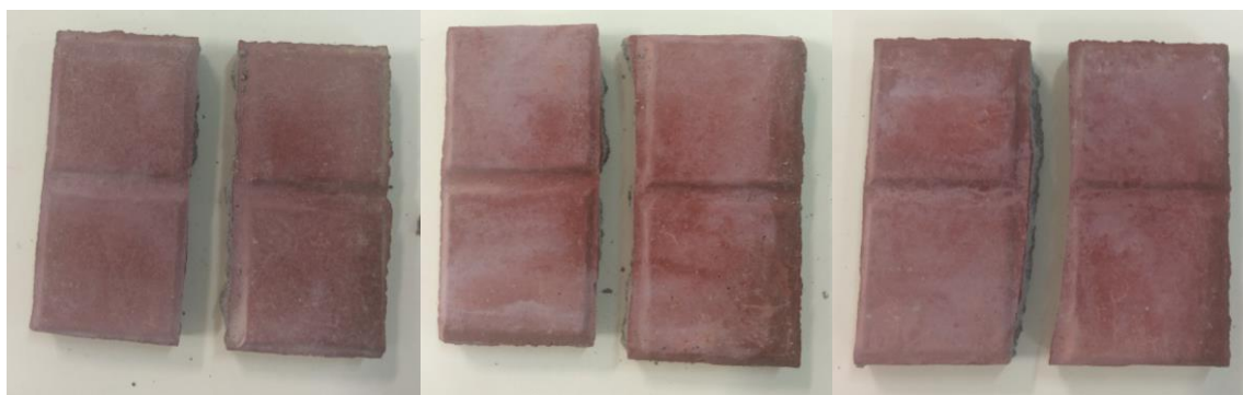
Figura 74: Peças utilizadas no ensaio de resistência à flexão dos ladrilhos hidráulicos pisos táteis
