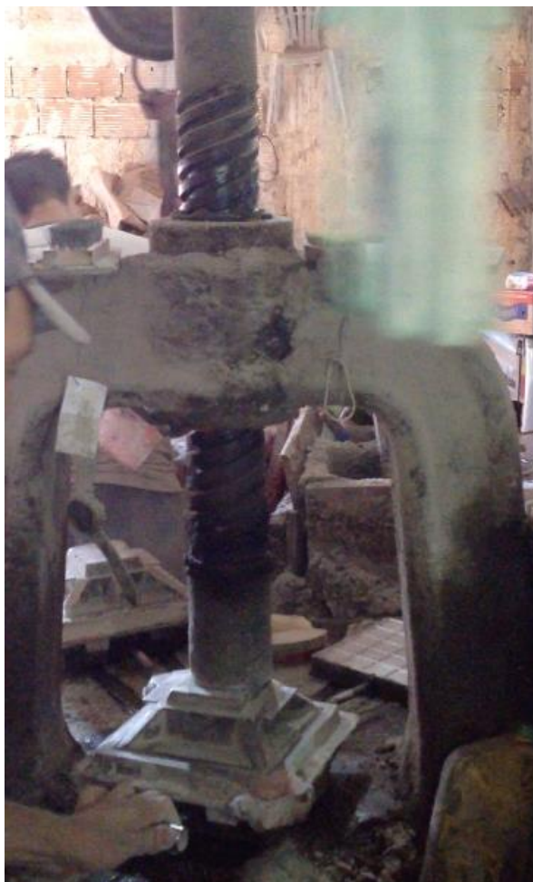
Figura 14: Prensagem do ladrilho hidráulico
