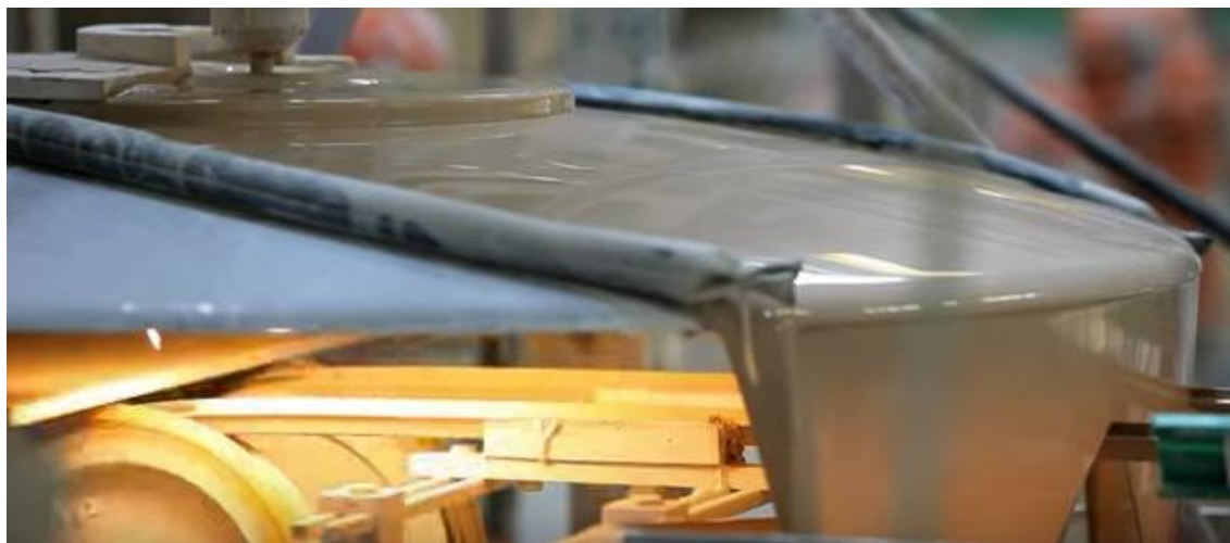
Figura 24: Processo de esmaltação
