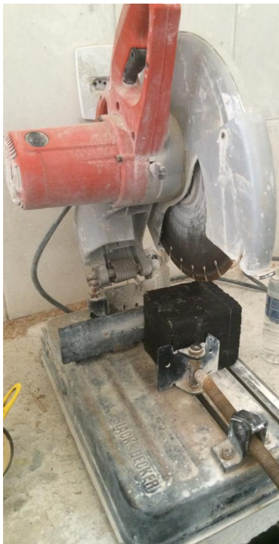
Figura 40: Corte dos ladrilhos de asfalto reciclado
