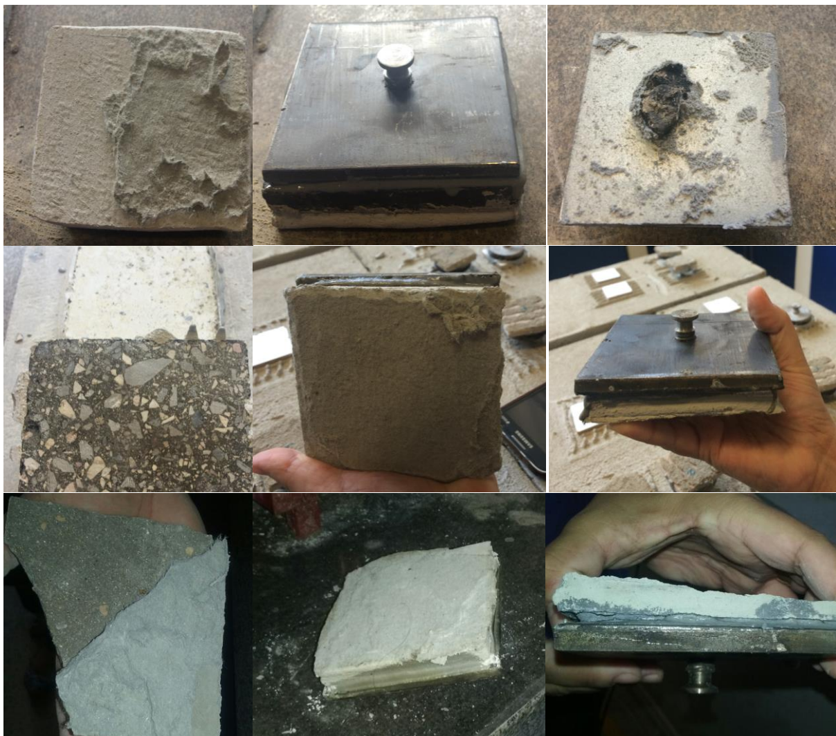
Figura 80: Tipos de ruptura ocorridos durante ensaio de arrancamento por tração
