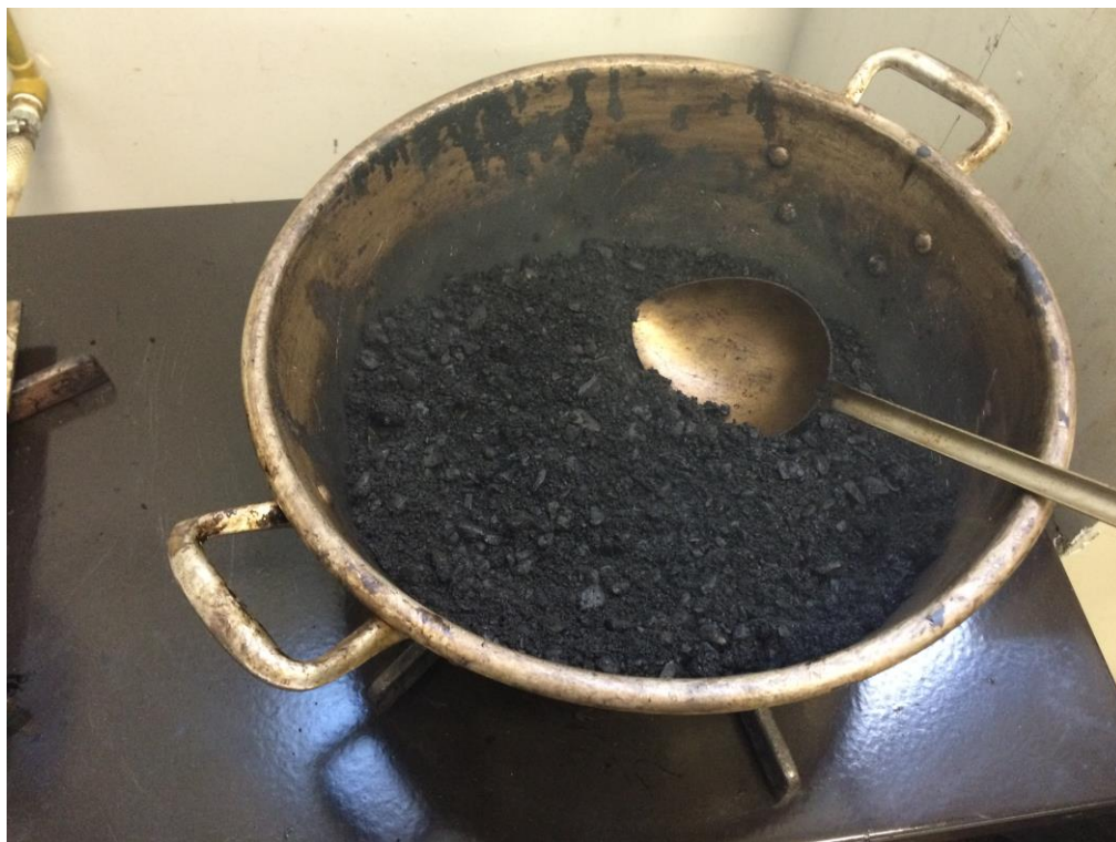
Figura 37: Aquecimento do CAF antes da prensagem
