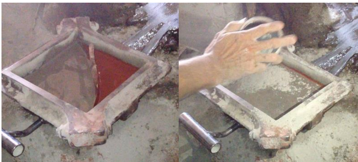
Figura 12: Adição de pigmento e acréscimo de secante
