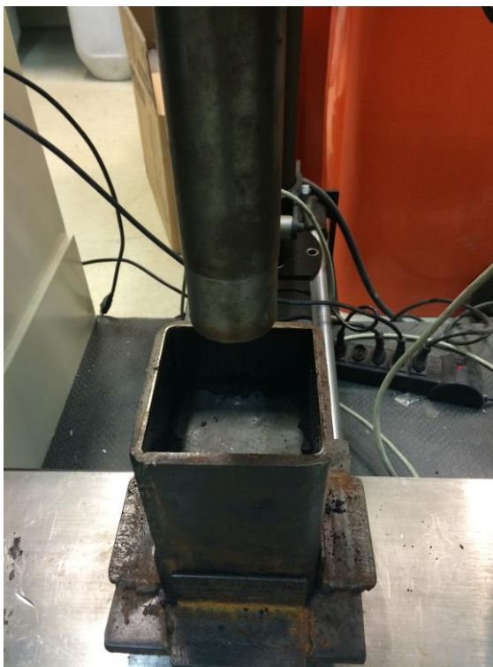
Figura 38: Prensagem do CAF aquecido
