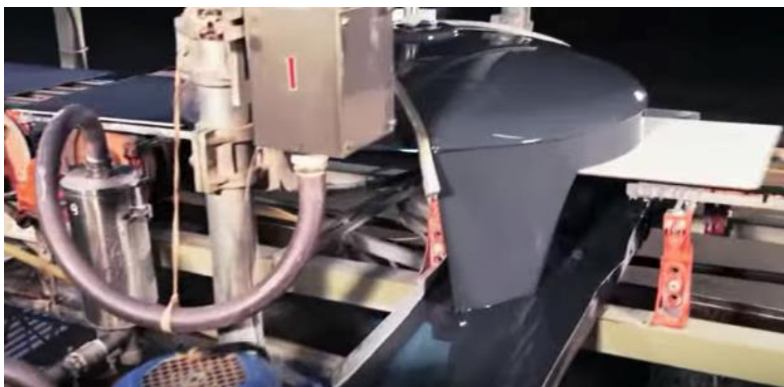
Figura 25: Aplicação de esmalte vitrificado
