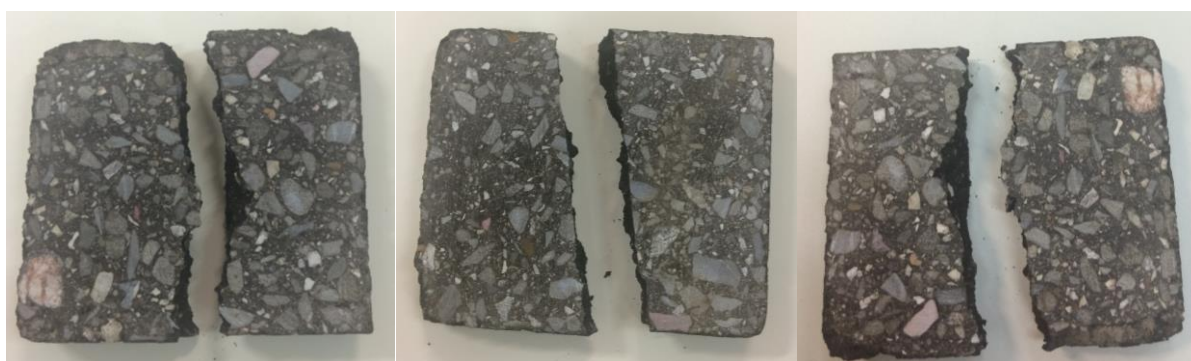
Figura 76: Peças utilizadas no ensaio de resistência à flexão dos ladrilhos de asfalto reciclado
