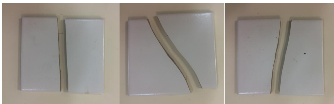
Figura 70: Peças utilizadas no ensaio de resistência à flexão dos ladrilhos cerâmicos
