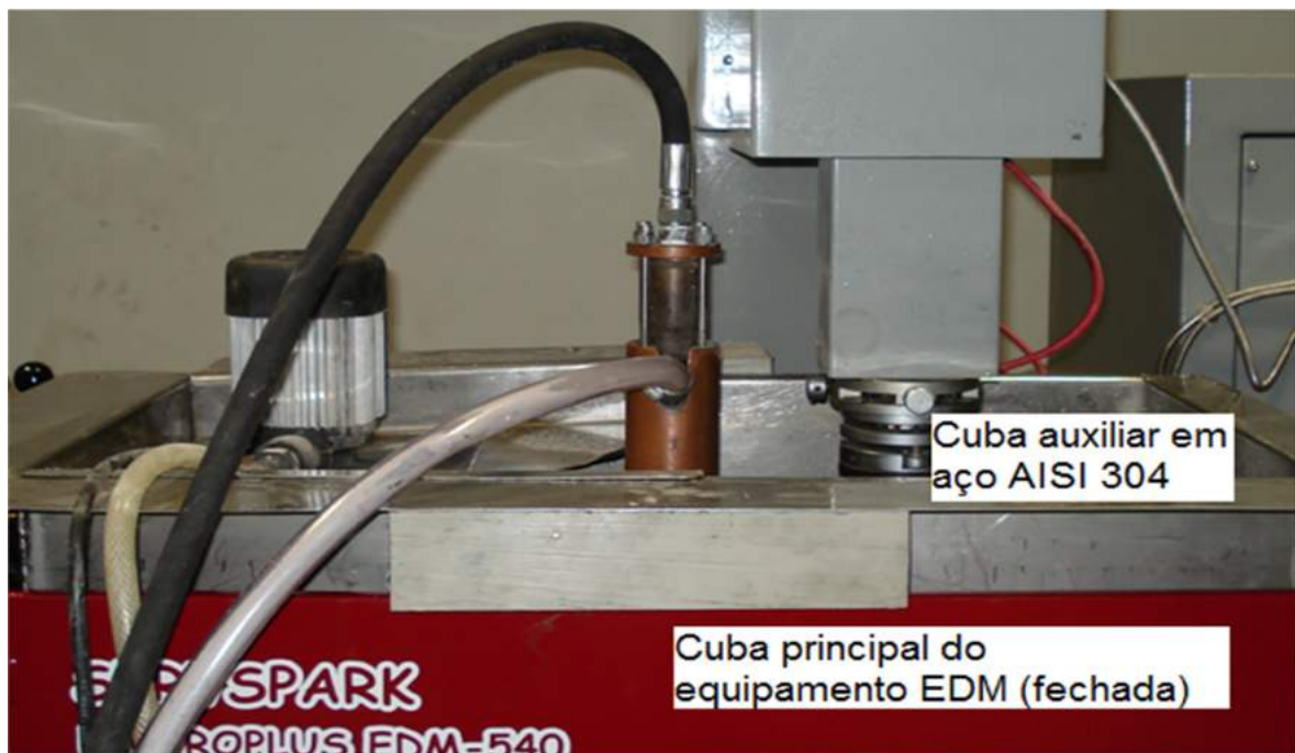
Figura 28 - Cuba auxiliar instalada no tanque principal do equipamento EDM.
