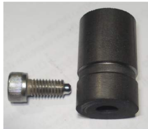
Figura 21 - Detalhe do canal no eletrodo de grafita e ponta do parafuso de fixação.
